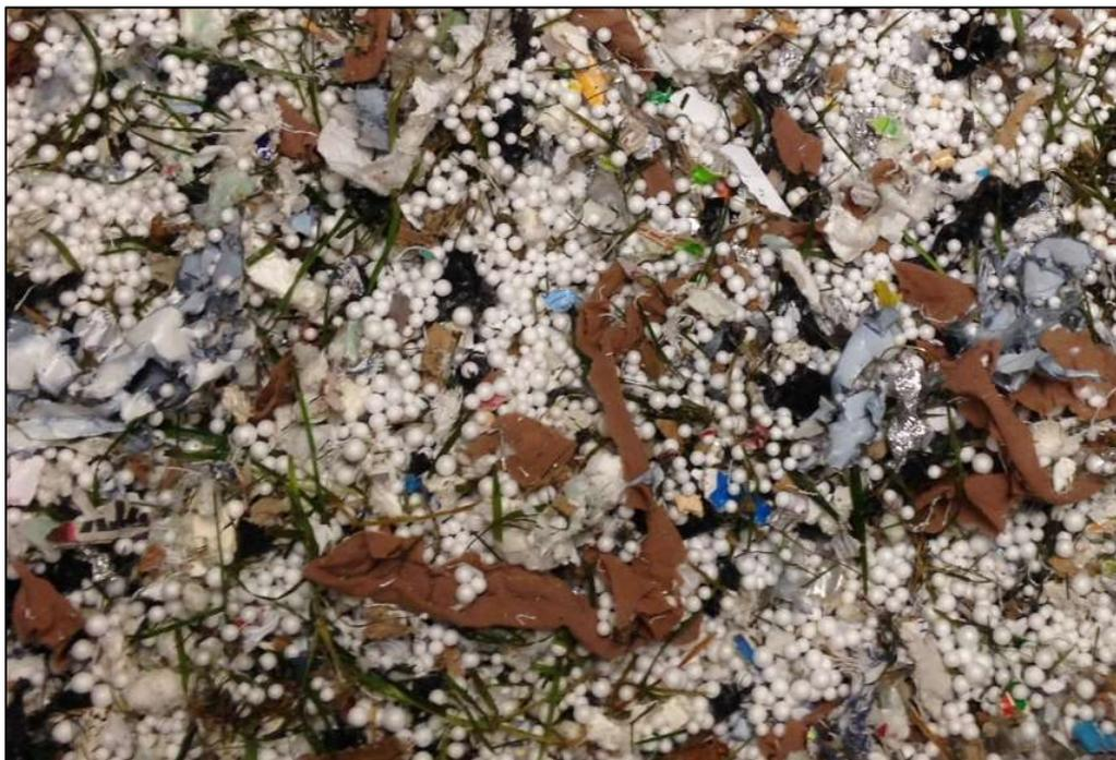
**Figure 22.** Première reconstitution d'OMR (aHSW-1) avec des billes de polystyrène.
