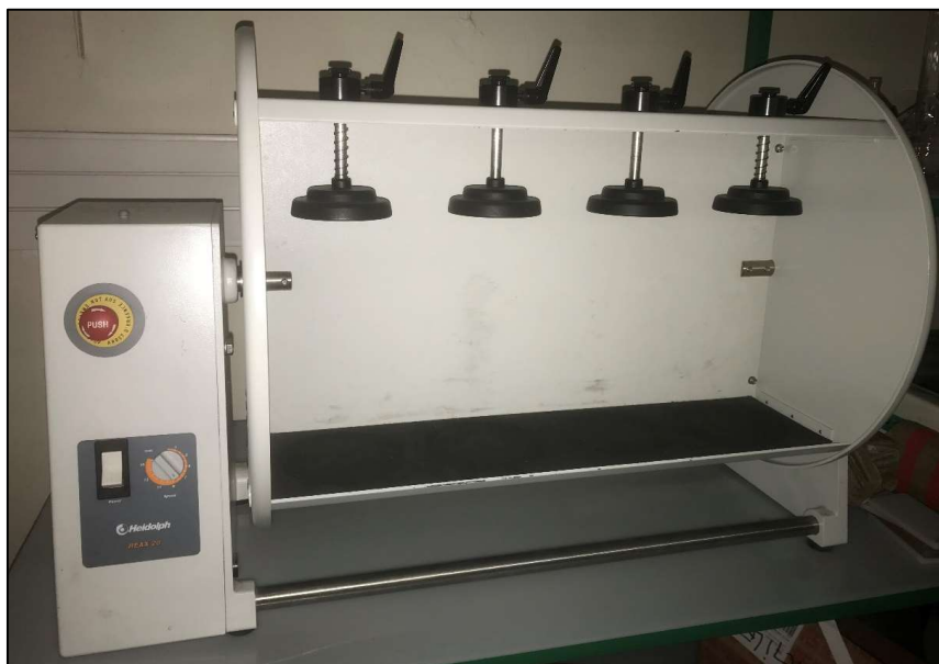
Figure 25. Dispositif d'agitation à retournement pour les tests de lixiviation.
