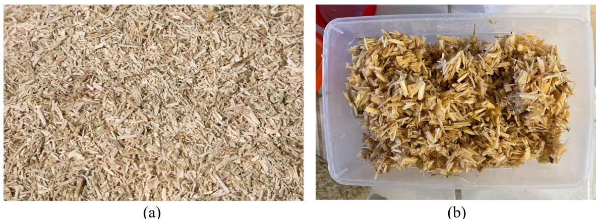
Figure 22 - Chênevotte Biofibat® (a) à l'état sec et (b) après essai d'absorption d'eau.
