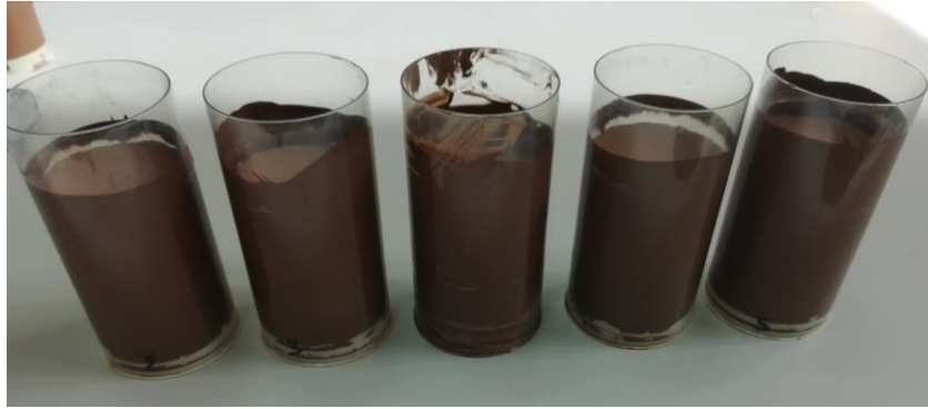
Figure IV.1. Échantillons de cake formé après plus de 3 semaines de décantation
