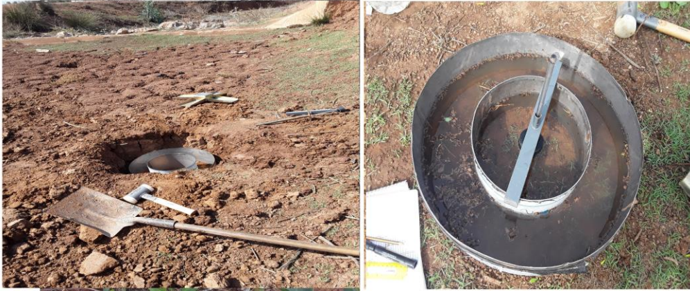
Figure I.23. Mesures de la conductivité hydraulique par le double anneau
