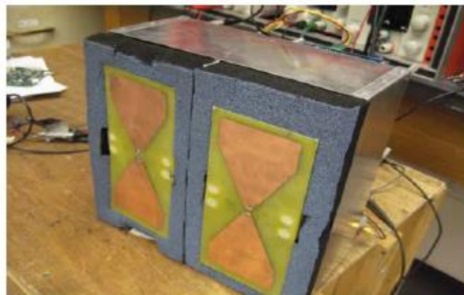
Figure I.7 – Antennes Bow-tie avec blindage pour la réduction du couplage et de la réflexion causées par le rayonnement des lobes arrière [CHENGUO2010].
