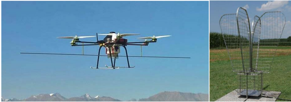
Figure I.38 – Mesure du diagramme de rayonnement d'une antenne fonctionnant à 50 MHz à l'aide d'un drone transportant un émetteur [PAONESSA2016].
