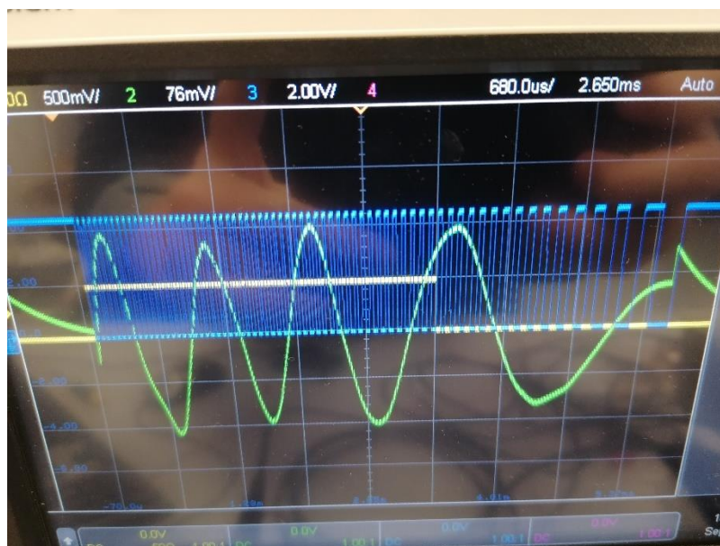
Figure II.78 – Signaux capturés par l'oscilloscope numérique : Trigger (jaune), signal de battement (vert) et signal d'horloge généré (bleu), cas N°1.
