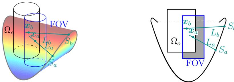
FIGURE 5.19 – Un exemple de FOV suffisant de type 1. En effet, le sommet du FOV est au-dessus de  $\Omega_{S_\lambda^2}$  et la base est au-dessous de  $\Omega_O$ .  $L_a$  et  $L_b$  sont des lignes M valides issues de  $S_a$  et  $S_b$  et peuvent être utilisées pour reconstruire  $x_a$  et  $x_b$ . Droite :  $\Omega_F$  est la région gris foncé.
