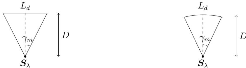
FIGURE 1.8 – Détecteurs avec une source  $S_\lambda$  émettant un faisceau de rayons  $X$ .  $L_d$  est la largeur du détecteur et  $D$  la distance entre la source et le centre du détecteur. *Gauche* : Cas d'un détecteur linéaire. *Droite* : Cas d'un détecteur en arc de cercle.
