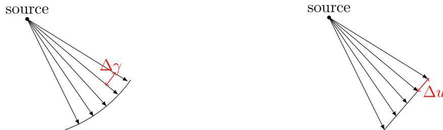
FIGURE 1.4 – *Gauche* : Echantillonnage équiangulaire pour détecteur circulaire à pas angulaire  $\Delta\gamma$ . *Droite* : Echantillonnage à espacement linéaire constant  $\Delta u$ .
