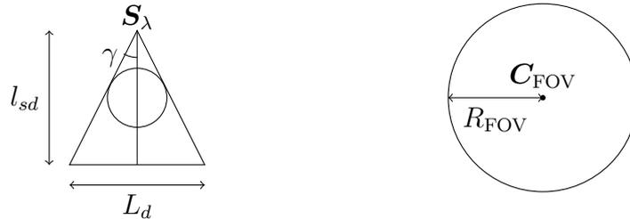
FIGURE D.1 – Paramétrisation de la source et du détecteur en projection sur le plan  $(\mathbf{e}_x, \mathbf{e}_y)$ .  $L_d$  est la largeur du détecteur et  $l_{sd}$  la distance source-détecteur.
