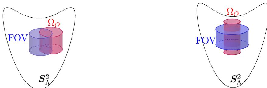
FIGURE 5.1 – La trajectoire selle  $S_A^2$  avec un FOV cylindrique et  $\Omega_O$  le support de l'objet. *Gauche* : Troncations transverses. *Droite* : Troncations axiales.
