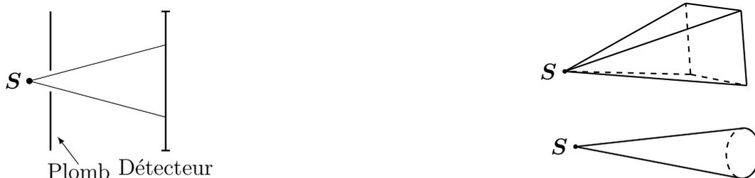
FIGURE 2.4 –  $S$  symbolise une source de rayons X. *Gauche* : Source collimatée avec détecteur. *Droite, haut* : Faisceau en cône pyramidal. *Droite, bas* : Faisceau en cône de révolution.
