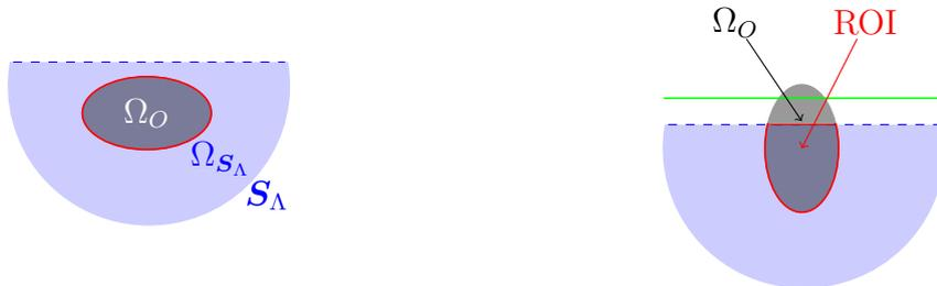
FIGURE 1.23 – Dans ces deux cas on peut reconstruire la ROI (contour rouge) définie ici par  $\Omega_O \cap \Omega_{S_\Lambda}$ . Pour la figure de droite c'est un résultat non trivial au vu des connaissances à la fin du XX<sup>e</sup> siècle (car par exemple la ligne verte n'est pas mesurée, ce qui correspond à une projection (horizontale) parallèle tronquée, et donc la méthode FBP ne peut s'appliquer).
