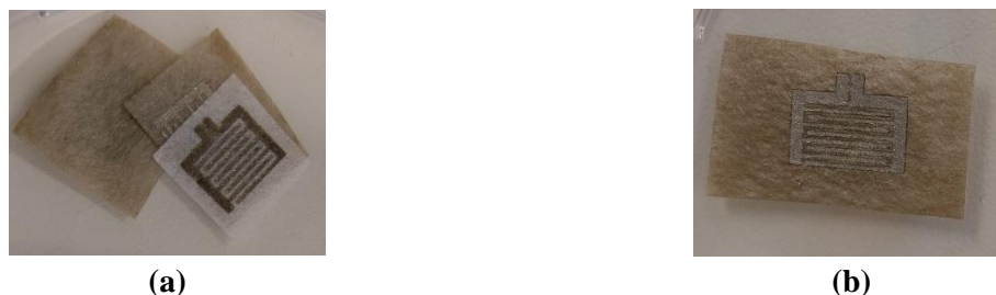
Figure 3.27. (a) Capteur à base de ZnO (blanc) et à base de ZnO-GO (beige) (b) Capteur à base de ZnO-GO par auto-assemblage couche par couche
