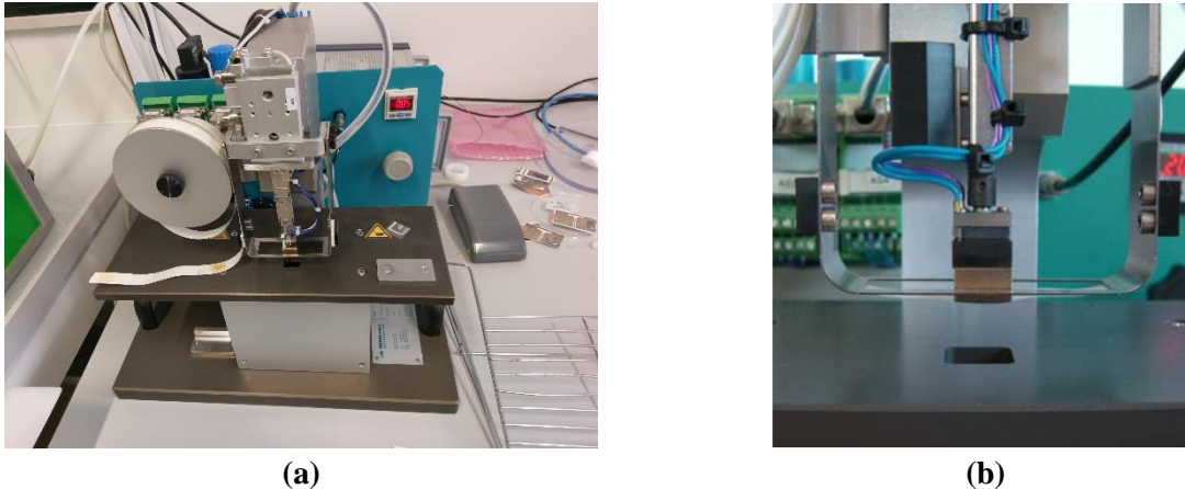
Figure 3.14. (a) Banc de test à thermodes TTS 300 de Mulbhauer (b) Thermode
