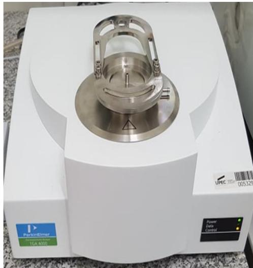
Figure.2.10 : Analyseur thermogravimétrique TGA 4000 (Perkin Elmer)
