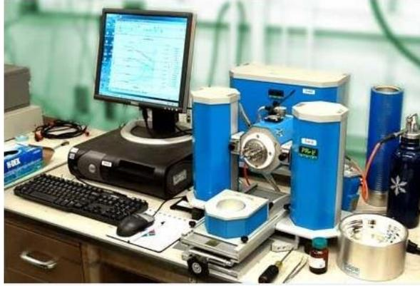
Figure.2.12 : Dispositif Tritec 2000 pour la réalisation de mesures par DMTA.
