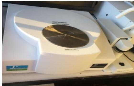
Figure.2.11 : Photo du dispositif de la technique DSC.
