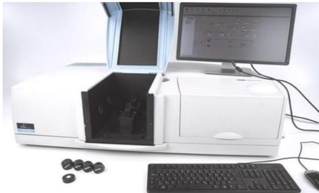
Figure.2.13 : Spectrophotomètre UV-VIS-NIR Lambda 750S UV-VIS-NIR (Perkin Elmer)
