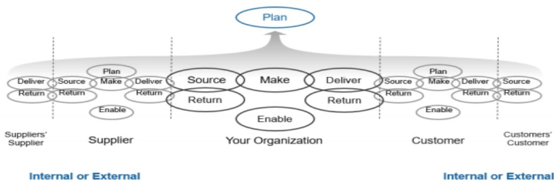
Figure II. 3 Schéma des processus logistiques du modèle SCOR. 12(SCC, 2017)
