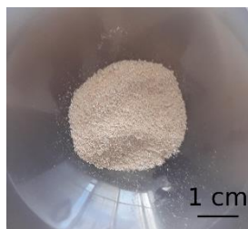
Figure SF-12: Image du matériau réactif CeMS constitué de microsphères de cérine
