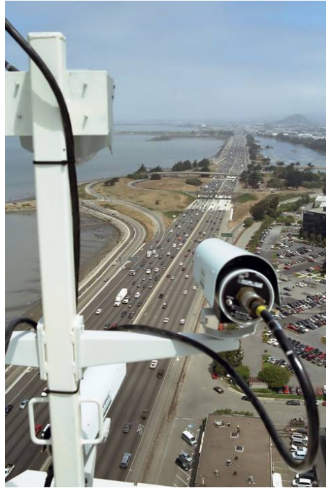
FIGURE 1.17 – Une caméra montée sur le toit d'un bâtiment qui couvre une section de l'autoroute I-80 enregistre les données des trajectoires des véhicules. [FHWA, 2008]
