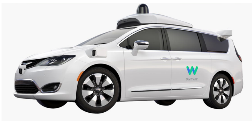
FIGURE 1.20 – La nouvelle voiture autonome de Waymo, équipée par un système de perception à trois LiDAR, des Radars et des caméras de conduite autonome [Waymo, 2021]
