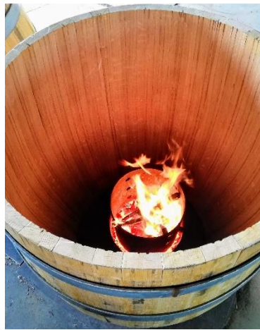
Figure 4. Chauffe aromatique de la barrique.
