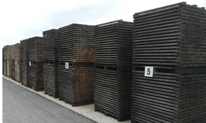
Figure 3. Empilement des merrains lors du séchage sur un parc à bois.
