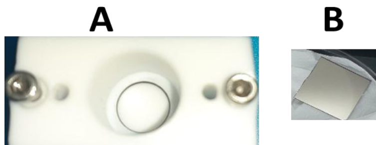
Figure 1 : Cellule (A) permettant d'accueillir l'électrode de Pt (B).
