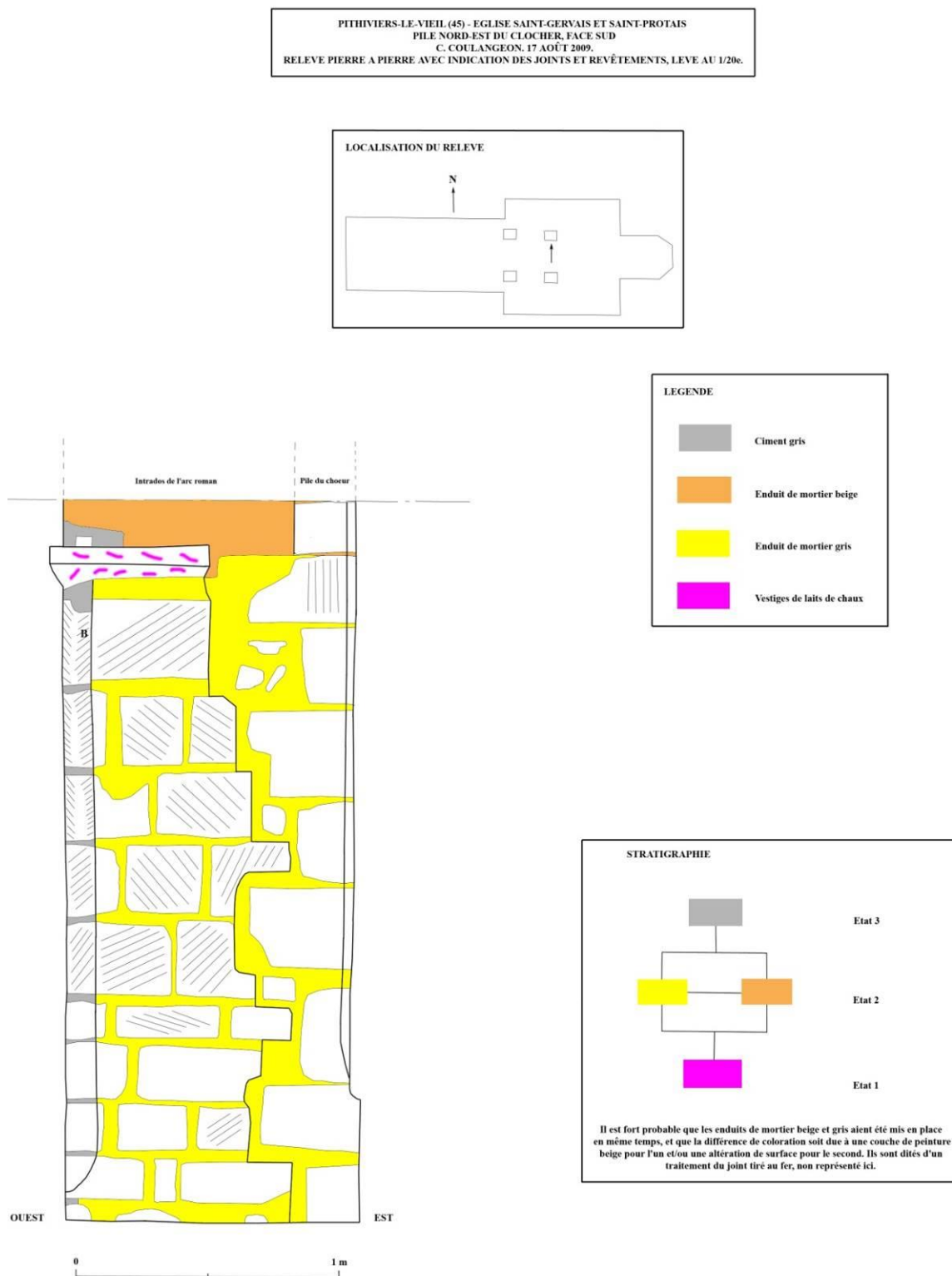
Fig. 11 : Relevé pierre à pierre avec indication des joints et revêtements de la face sud de la pile nord-est du clocher.
