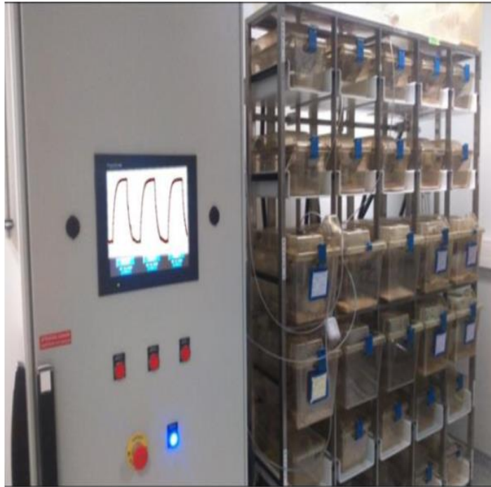
Figure 15: Dispositif d'exposition des rongeurs à l'hypoxie intermittente.
