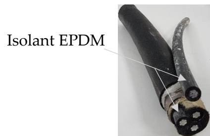
Figure II-1. Câble électrique haute tension
