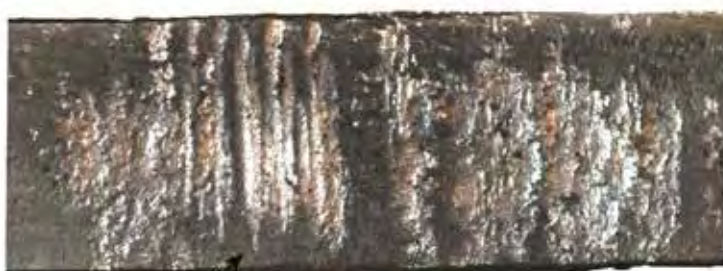
Fig. 246 - Barres à 11,5 % d'étain dont la face interne a été partiellement martelée pour tester le cintrage – clichés M. Nordez. La barre n° 1 a subi un recuit à 700°, la barre n° 2 est brute de fonderie.
