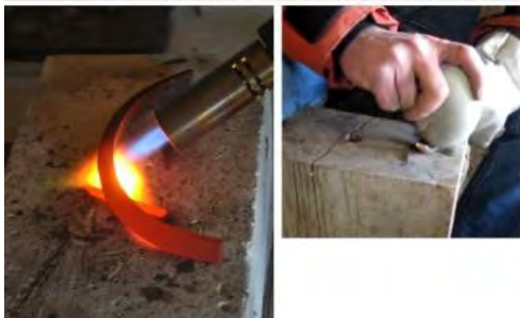
Fig. 245 - Expérimentation du cintrage d'une barre en bronze à environ 11 % d'étain, dont la face interne est martelée sur un creux ménagé dans un billot de bois dur à l'aide d'un gros galet de quartz – clichés M. Nordez.
