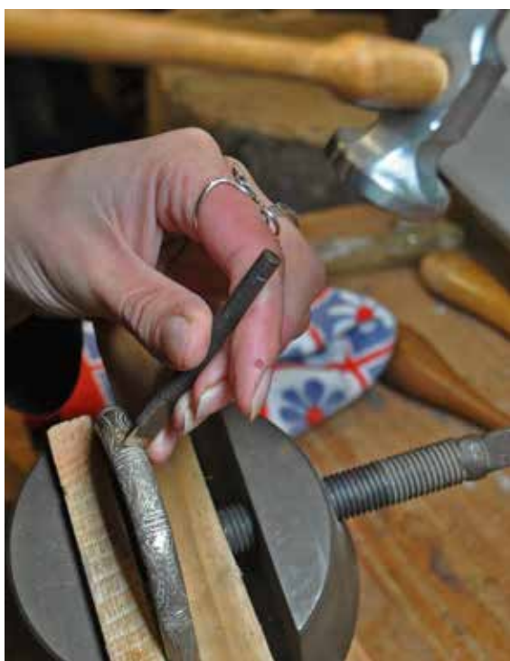
Fig. 254 - La ciselure sur fondu : les motifs venus à la fonte sont retravaillés à l'aide du tranchant du ciselet, la partie dormante de ce dernier étant martelée pour permettre la pénétration dans le bronze massif – cliché M. Nordez.
