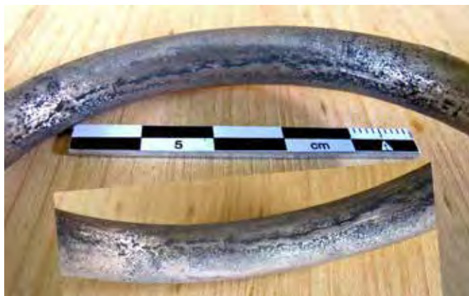
Fig. 243 - Sillons de part et d'autre de la bavure de coulée sur un anneau expérimental – clichés M. Nordez.
