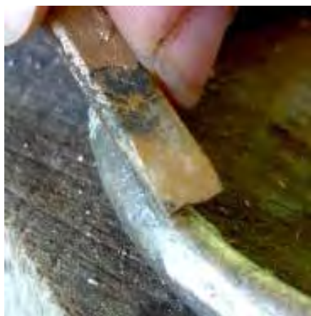
Fig. 248 - Déformation du tranchant écroui d'un ciselet à 15 % d'étain après seulement trois tentatives de ciselures sur une barre de bronze à 10,9 % d'étain – cliché M. Nordez.
