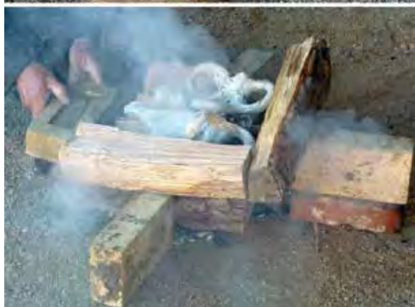
Fig. 260 - Décirage (en haut) et cuisson des moules (en bas) – clichés M. Nordez.
