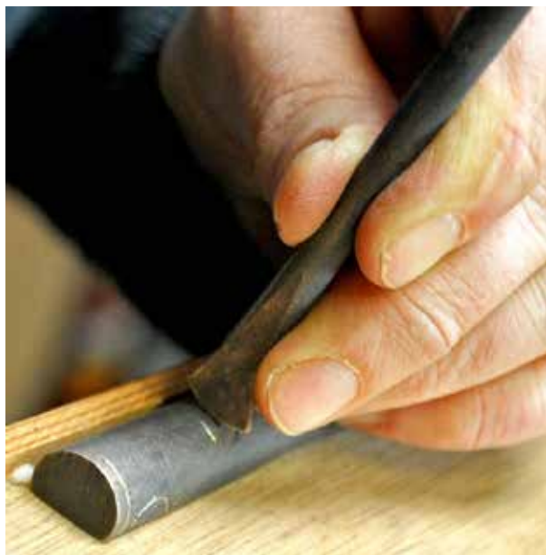
Fig. 250 - Ciselure d'une barre de bronze à 12 % d'étain recuite et trempée, avec un ciselet de même composition dont le tranchant a été martelé – cliché M. Nordez.
