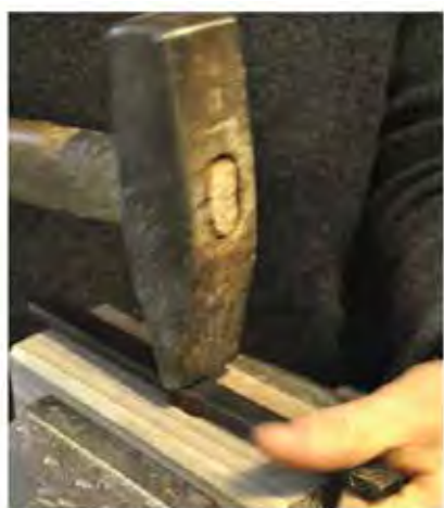
Fig. 246 - Barres à 11,5 % d'étain dont la face interne a été partiellement martelée pour tester le cintrage – clichés M. Nordez. La barre n° 1 a subi un recuit à 700°, la barre n° 2 est brute de fonderie.
