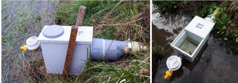
*Figure 18. Photographies du dispositif de récupération des eaux de drains*
