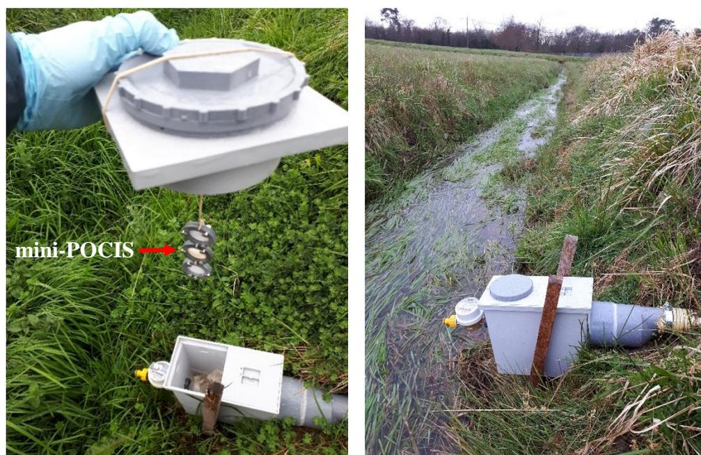
Figure 23. Photographies de la mise en place du dispositif de suivi des eaux de drains
