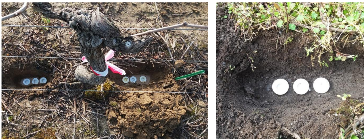
Figure 22. Photographies de la mise en place des DGT
