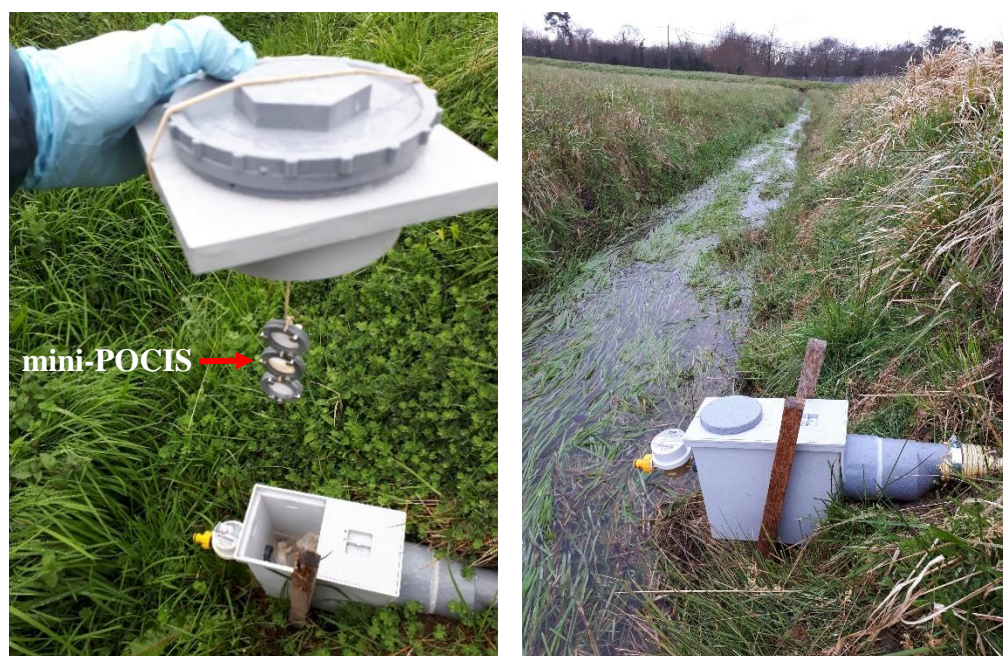
Figure 23. Photographies de la mise en place du dispositif de suivi des eaux de drains
