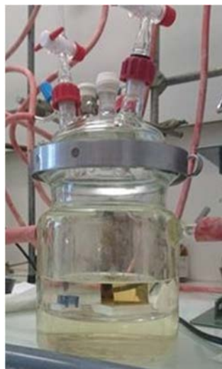
Figure 15. Photographie d'un réacteur à double paroi utilisé pour les greffages par immersion
