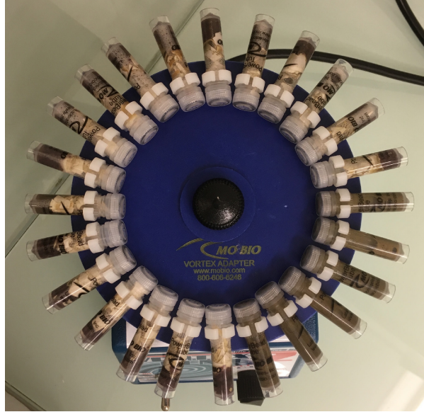
FIGURE 2.9 – Illustration de l'étape de lyse mécanique par vibrobroyage.
