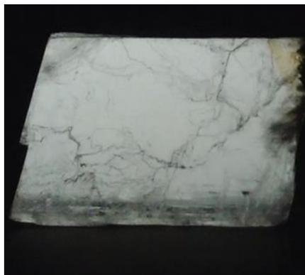
Figure 4. Photographie d'un cristal biréfringent de calcite observé entre polariseurs croisés
