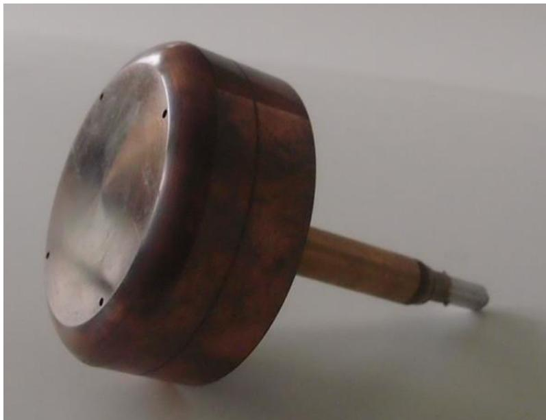
*Figure 12. Anode tournante en cuivre.*
