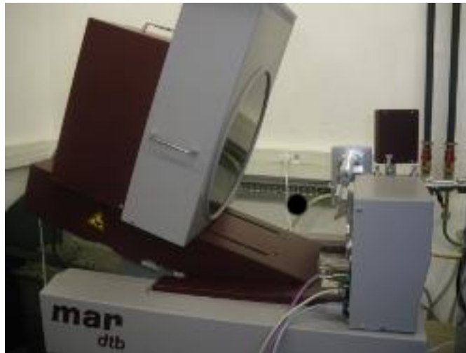
Figure 16. Photographie du dispositif de diffractométrie de rayons X
