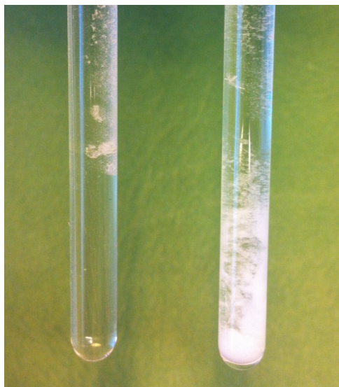
Figure 41 : échantillons de lysozyme ( c = 1 \text{ mM} dans un tampon PBS 10 \text{ mM} , \text{pH } 7 ) en l'absence (à gauche) et en présence (à droite) de [\text{Na}]_3[\text{Pr}(\text{DPA})_3] ( c = 1 \text{ mM} ).
