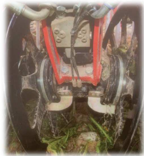
b) Roues Opel pour l'arrachage
