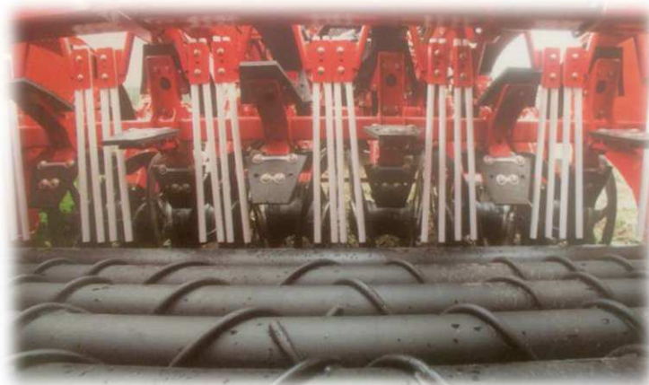
Figure n°15 : Table à rouleaux pour le déterrage [Grimme, 2016].
