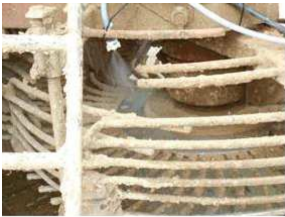
a) Turbines de nettoyage de l'arracheuse équipées d'un pulvérisateur à chaux
