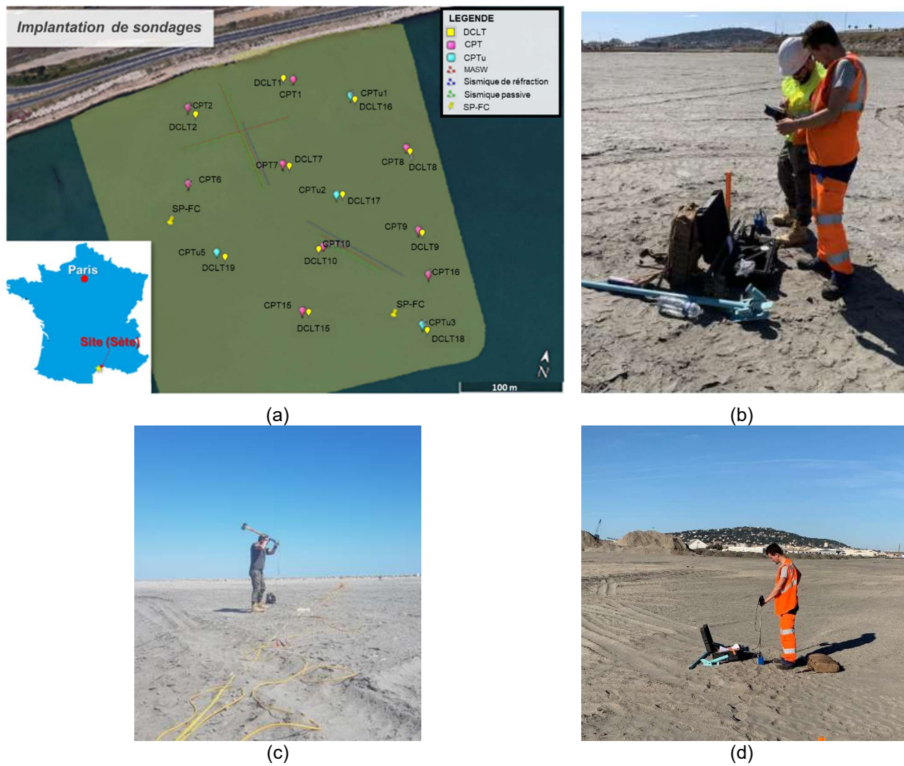
Figure IV.2. Campagne expérimentale réalisée sur le site de Sète : (a) localisation du site en France et implantation de sondages, (b) réalisation de l'essai Panda, (c) réalisation d'essai sismique MASW et (d) réalisation d'essai Panda
