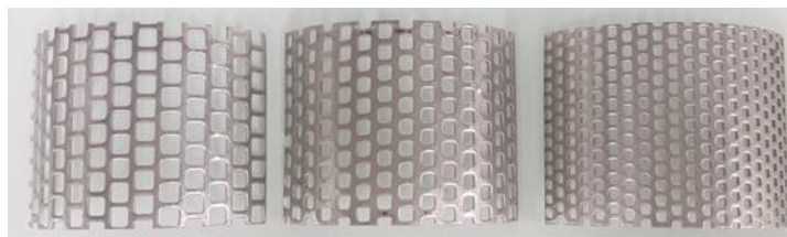
Figure II-12 : Différentes tailles de grilles 8, 6 et 4 mm
