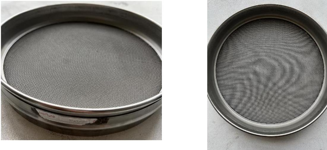
Figure II-13 : Tamis de 800 $\mu$ m utilisé pour le broyage
