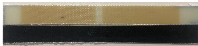
Figure III-14 : Comparaison de la coloration des composites Elium®/verre en haut et Elium®/basalte en bas après 1 mois de vieillissement UV
