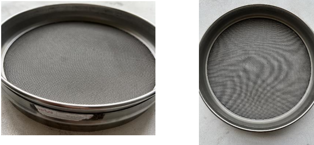
Figure II-13 : Tamis de 800 \mu m utilisé pour le broyage
