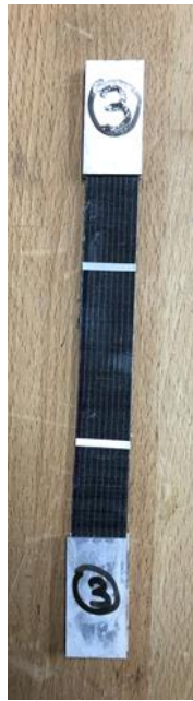
Figure II-18: Exemple d'éprouvette préparée pour l'essai de traction basalte/ELIUM®
