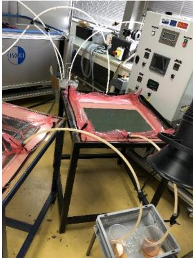
Figure II-5: Vue générale sur le dispositif d'infusion
