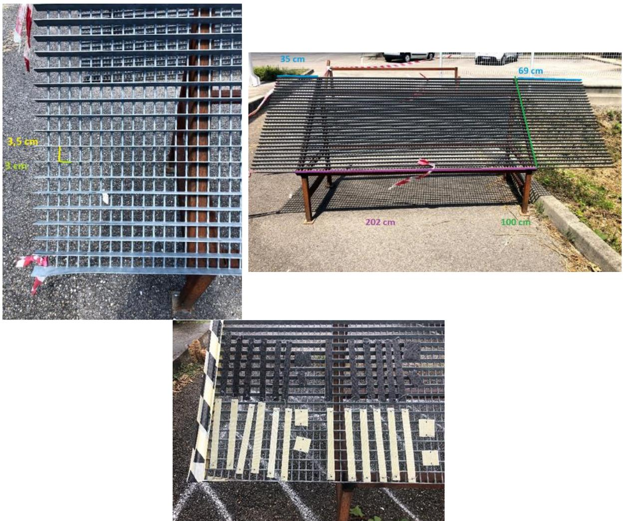
Figure II-7: Rack de vieillissement et dimensions
