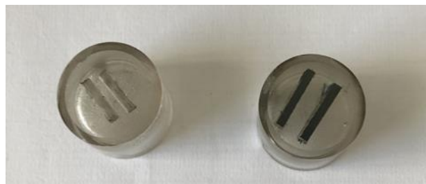
Figure II-21: Sections polies avec échantillons à observer composite Elium®/verre à gauche et composite Elium®/basalte à droite
