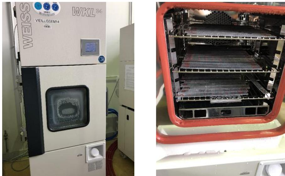
Figure II-8: Enceinte Weiss de vieillissement hygrothermique
