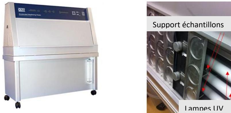
Figure II-9: Enceinte QUV de vieillissement UV et ses porte échantillons
