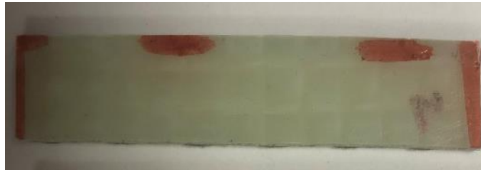
Figure II-20 : Echantillons de composite verre/ELium® de dimension 5x1 cm 2 pour un essai de DMA
