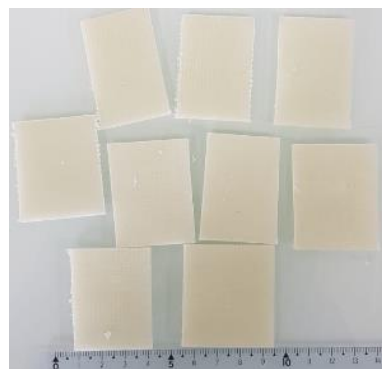
Figure II-10: Morceaux de composites Elium®/Verre prédécoupés pour broyage
