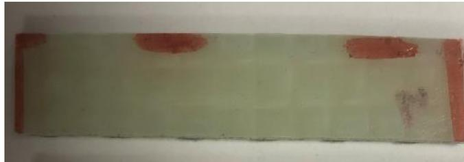
Figure II-20 : Echantillons de composite verre/ELium® de dimension 5x1 cm<sup>2</sup> pour un essai de DMA
