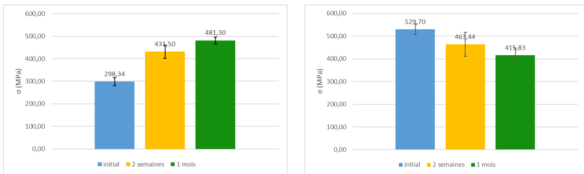
a) b) Figure III-20 : Contrainte à rupture des composites a) Elium®/verre et b) Elium®/basalte à l'état initial, après 2 semaines et 1 mois d'exposition UV
