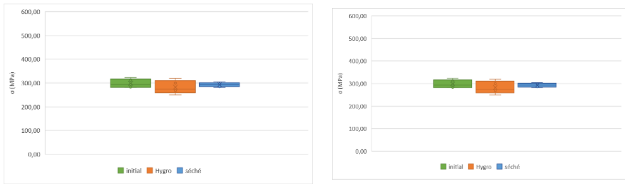
Figure III-12 : Evolution des contraintes à rupture à l'état initial, après vieillissement hygrothermique et après séchage pour a) composite Elium®/verre et b) composite Elium®/basalte
