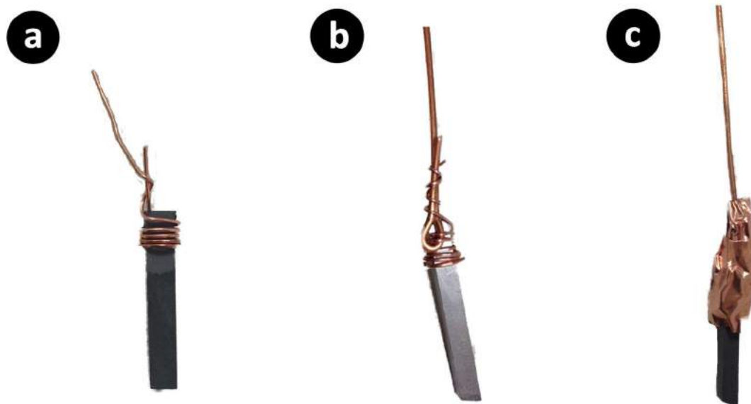
Figure 2-7 : Photographies du système d'attache des électrodes composites : a) fil de 0,5 mm, b) fil de 1mm, c) « gaine » en feuille de cuivre
