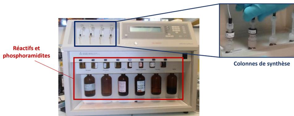
**Figure 47 : Synthétiseur à oligonucléotides utilisé pour la fonctionnalisation des NP de silice.**
