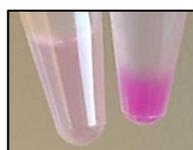
Figure 76 : Sédimentation des NP-ADIBO/DOTA(10) après ajustement du pH à 6,5.
