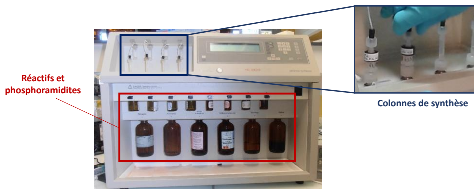
Figure 47 : Synthétiseur à oligonucléotides utilisé pour la fonctionnalisation des NP de silice.
