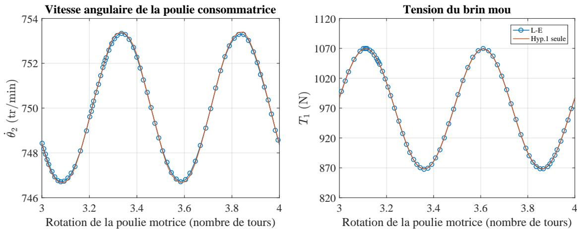
FIGURE 2.27 – Degré d'influence des hypothèses sur le comportement prédit de la variante  $V_{ref}$  de la transmission étudiée en section 2.3 : vitesse angulaire  $\dot{\theta}_2$  de la poulie consommatrice (a) et effort de tension  $T_1$  dans le brin mou
