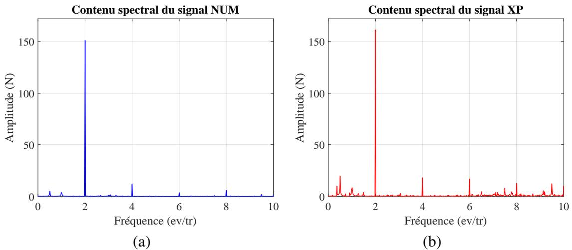
FIGURE 4.8 – Contenu spectral des signaux numérique (a) et expérimental (b) de l’effort de tension dans le brin tendu  $T_1$  pour un régime moteur stabilisé à 1500 tr/min
