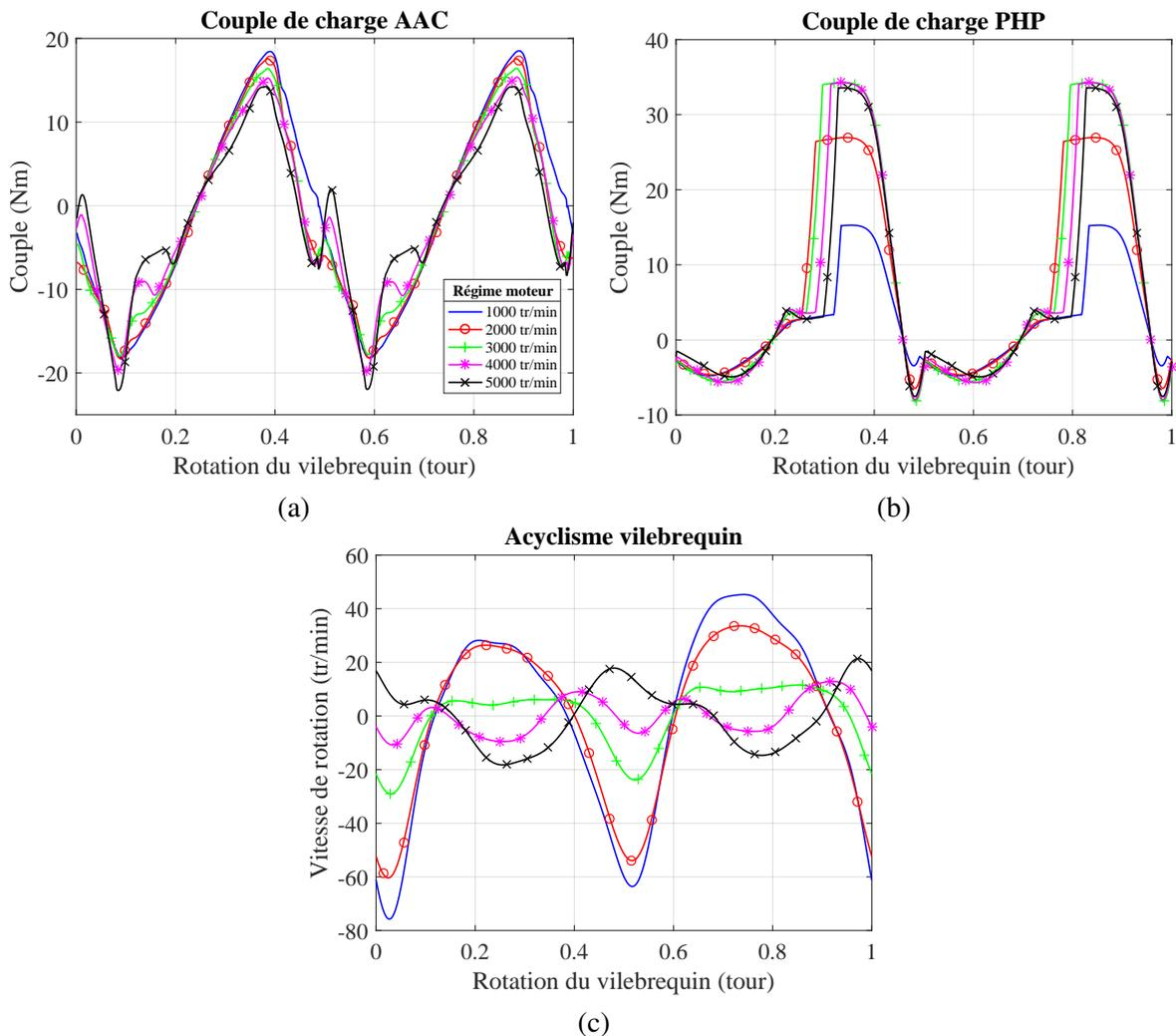
FIGURE 1.11 – Excitations angulaires<sup>2</sup> affectant la façade du moteur PSA DW10F : couples de charge fluctuant AAC (a) et PHP (b), acyclisme vilebrequin (c)
