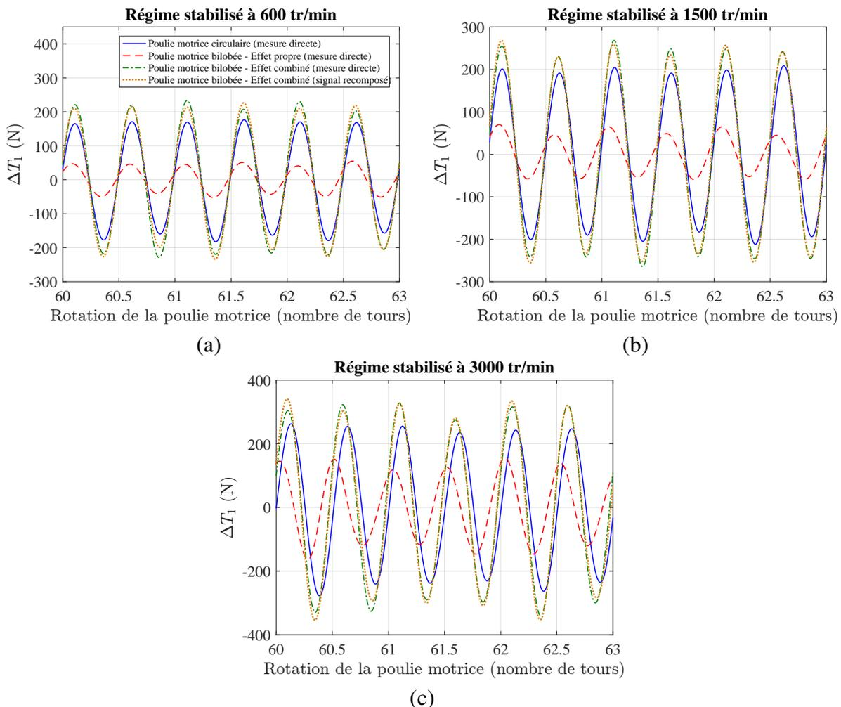
FIGURE 3.32 – Transmission académique sans tendeur : mise en évidence du comportement linéaire de la transmission par vérification du principe de superposition sur les variations de l'effort de **tension dans le brin tendu** pour des régimes stabilisés à 600 tr/min (a), 1500 tr/min (b), 3000 tr/min (c) et un calage de la poulie motrice bilobée à la dent N°3
