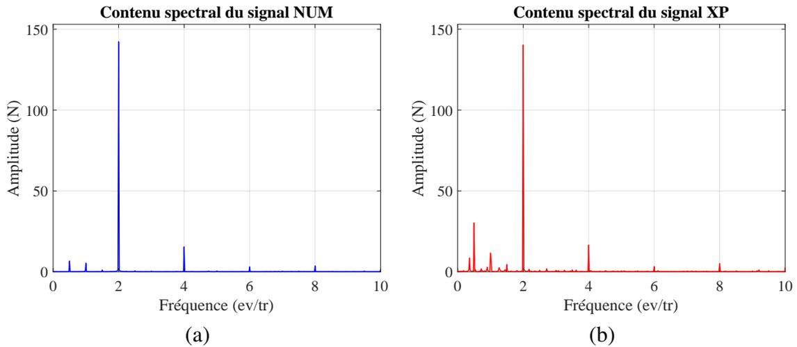
FIGURE 4.7 – Contenu spectral des signaux numérique (a) et expérimental (b) de l’effort de tension dans le brin tendu  $T_1$  pour un régime moteur stabilisé à 600 tr/min
