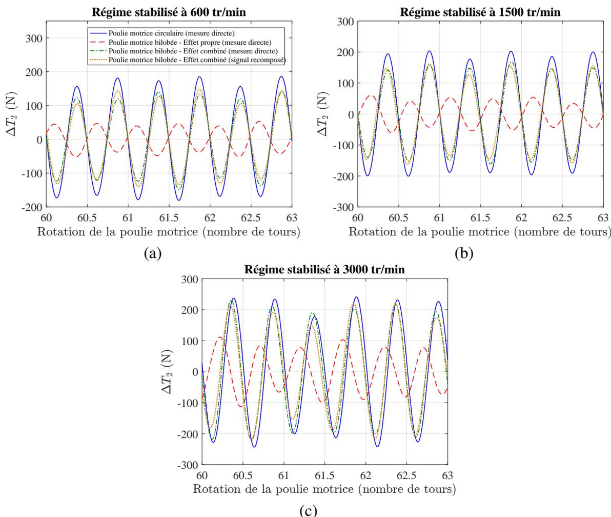
FIGURE 3.33 – Transmission académique sans tendeur : mise en évidence du comportement linéaire de la transmission par vérification du principe de superposition sur les variations de l’effort de **tension dans le brin mou** pour des régimes stabilisés à 600 tr/min (a), 1500 tr/min (b), 3000 tr/min (c) et un calage de la poulie motrice bilobée à la dent N°3
