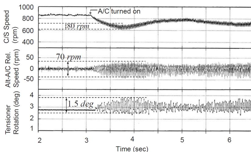
FIGURE C.4 - Réponse dynamique mesurée expérimentalement [Parker 04]
