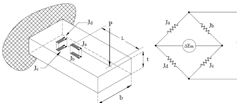
FIGURE 3.13 – Principe de mesure de la déformation en flexion d’une plaque à partir d’un montage de deux jauges en L en pont complet
