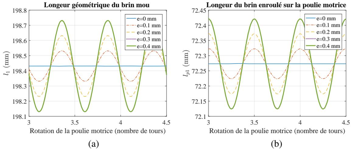
FIGURE 2.15 – Influence du niveau d'excentricité  $e$  de la poulie motrice elliptique sur les longueurs géométriques (a) du brin mou  $l_1$  et (b) du brin enroulé sur la poulie motrice  $l_{p1}$  ( $\theta_{01} = 0^\circ$ )
