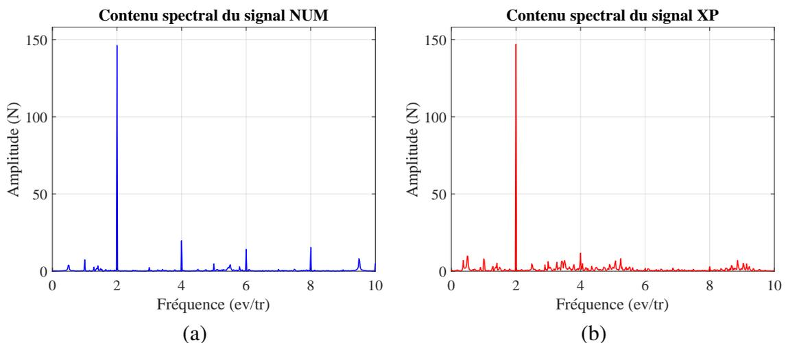
FIGURE 4.9 – Contenu spectral des signaux numérique (a) et expérimental (b) de l’effort de tension dans le brin tendu  $T_1$  pour un régime moteur stabilisé à 3000 tr/min
