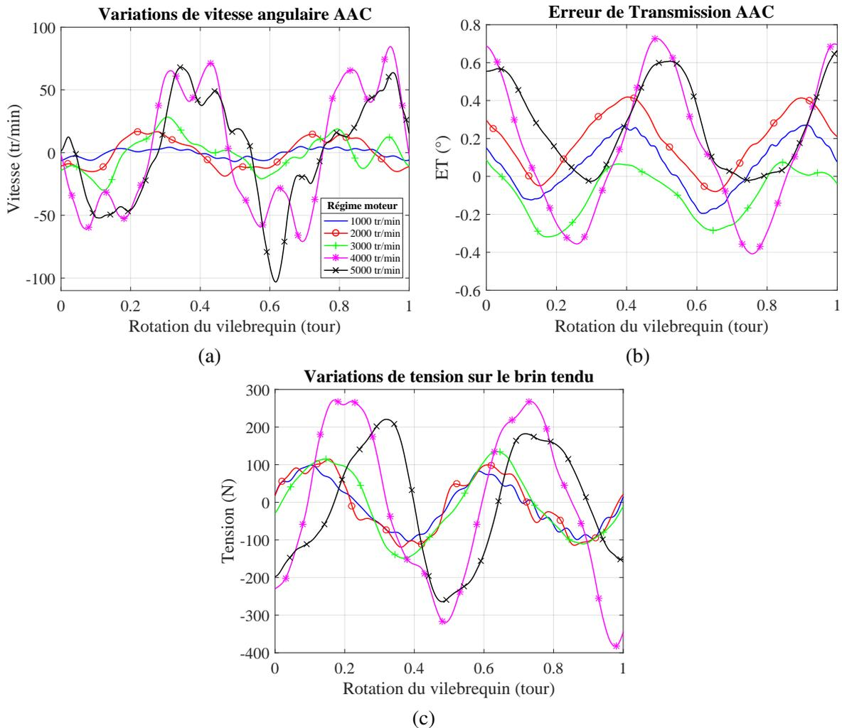
FIGURE 1.12 – Réponse angulaire<sup>3</sup> de la façade du moteur PSA DW10F sous l'effet excitateur du couple arbre-à-came : variations de la vitesse angulaire (a) et de l'erreur de transmission (b) de la poulie AAC, variations de l'effort de tension dans le brin tendu de la transmission (c)
