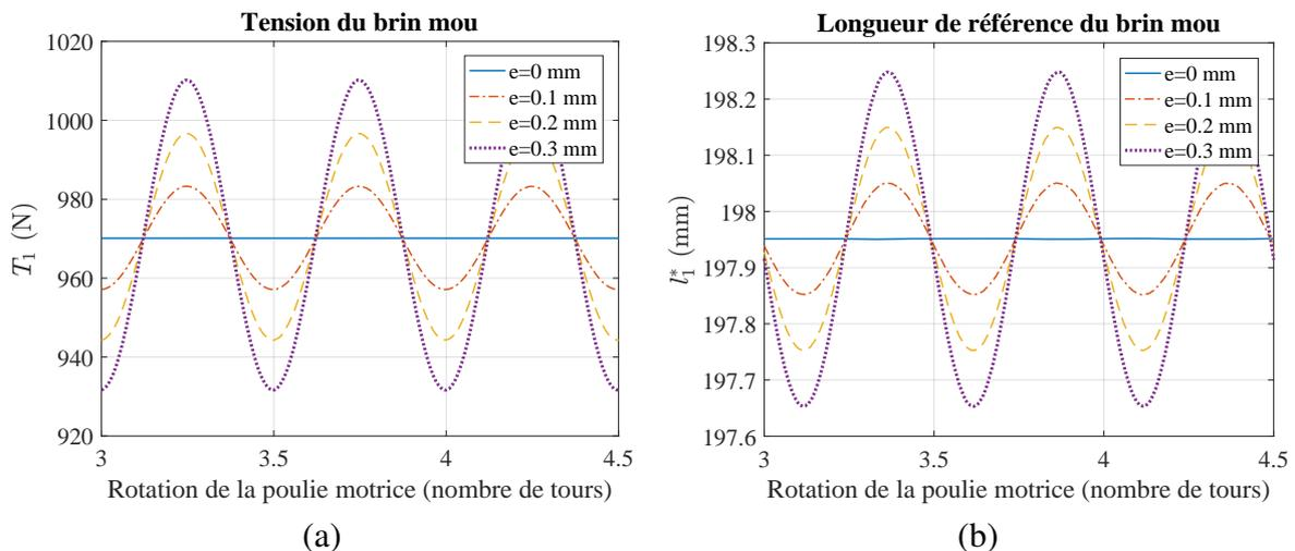
FIGURE 2.20 – Effet du niveau d'excentricité  $e$  de la poulie motrice elliptique sur (a) les efforts de tension  $T_1$  et (b) la longueur de référence  $l_1^*$  du brin mou de la transmission dans sa variante  $V_{el}$  ( $\theta_{01} = 0^\circ$ )
