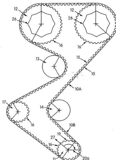
FIGURE 1.25 – Façade de distribution d'un moteur quatre cylindres à double arbres-à-cames en tête [Gajewski 06]
