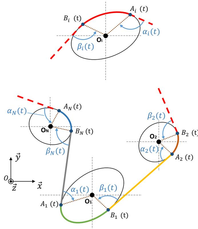
FIGURE 2.2 – Orientation des brins libres en configuration courante  $C^t$
