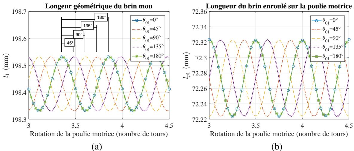
FIGURE 2.14 – Influence de l'angle de calage initial  $\theta_{01}$  de la poulie motrice elliptique sur les longueurs géométriques (a) du brin mou  $l_1$  et (b) du brin enroulé sur la poulie motrice  $l_{p1}$  ( $e = 0.1$  mm)
