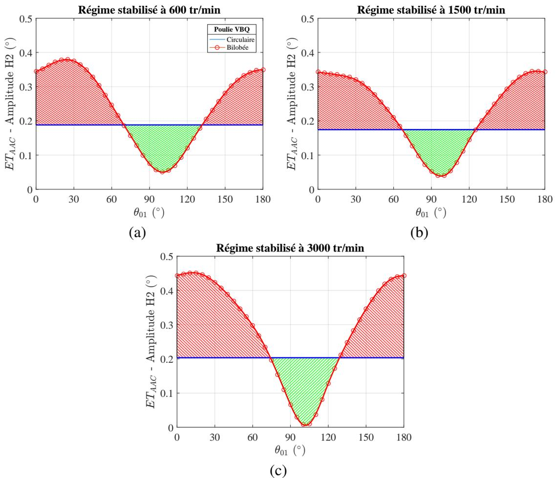
FIGURE 3.45 – Façade de distribution du GMP PSA DW10F dotée de la poulie de vilebrequin bilobée : influence de l'angle de calage de la poulie de vilebrequin sur l'harmonique H2 de l'**erreur de transmission** de a poulie AAC pour des régimes stabilisés à 600 tr/min (a), 1500 tr/min (b) et 3000 tr/min (c)
