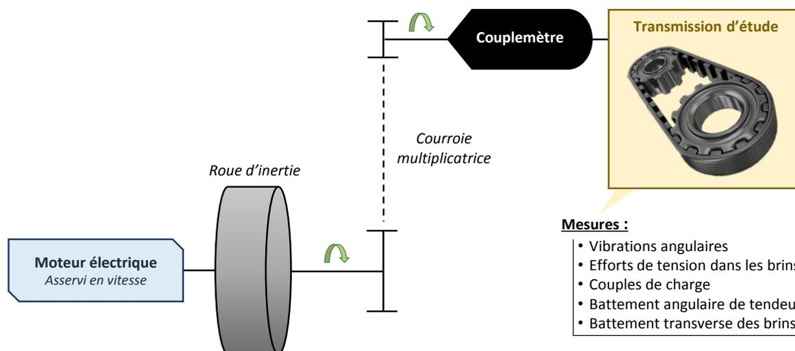
FIGURE 3.1 – Schéma de principe du dispositif expérimental
