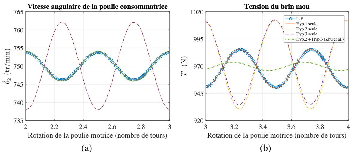
FIGURE 2.28 – Degré d'influence des hypothèses sur le comportement prédit de la variante  $V_{el}$  de la transmission étudiée en section 2.3 : vitesse angulaire  $\dot{\theta}_2$  de la poulie consommatrice (a) et effort de tension  $T_1$  dans le brin mou ( $e = 0.25$  mm et  $\theta_{01} = 0^\circ$ )
