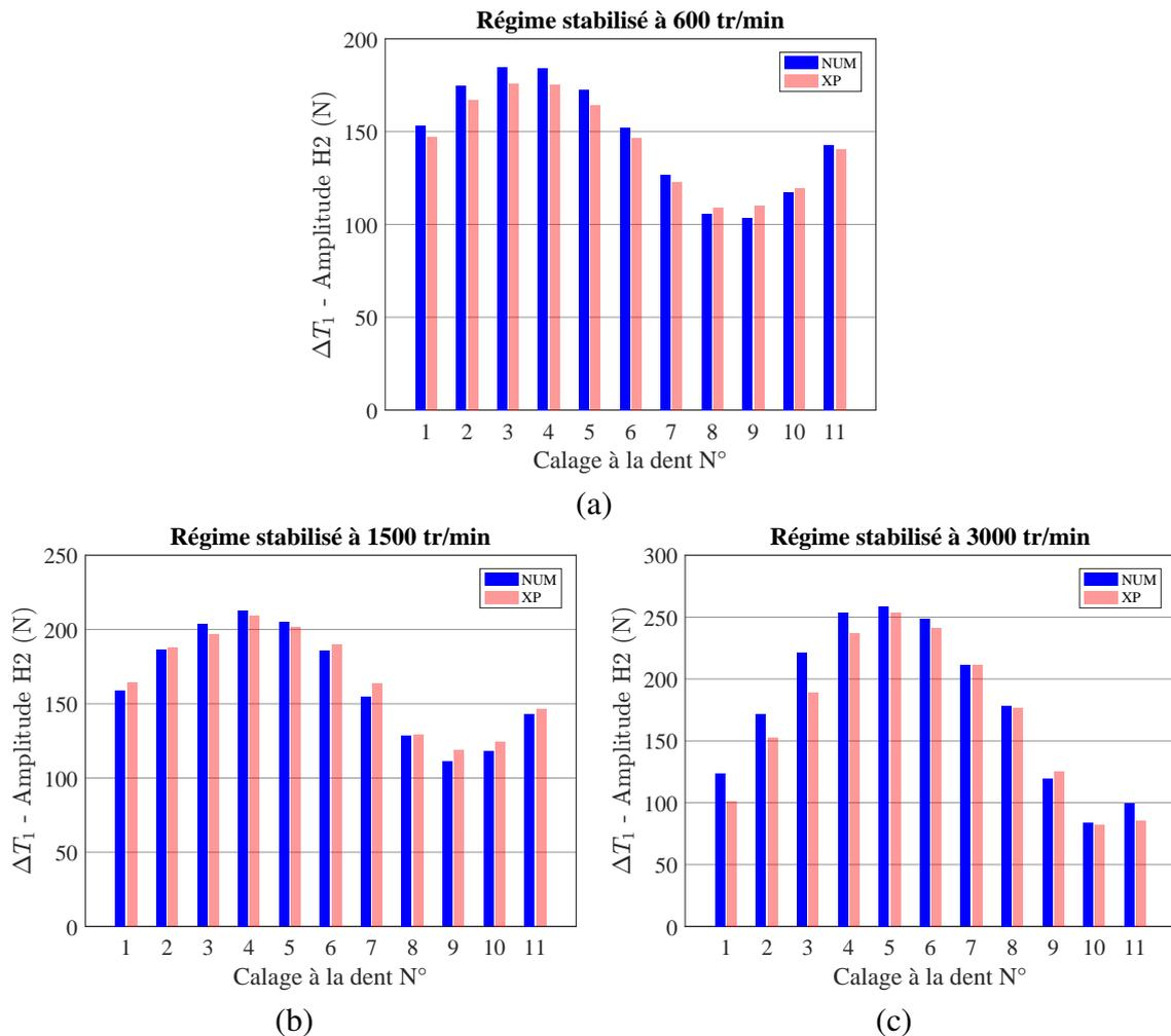
FIGURE 4.27 – Influence de l'angle de calage de la poulie motrice bilobée sur l'amplitude de l'harmonique H2 des signaux expérimental et numérique de l'effort de tension dans le brin tendu  $T_1$  pour des régimes moteur stabilisés à 600 (a), 1500 (b) et 3000 (c) tr/min
