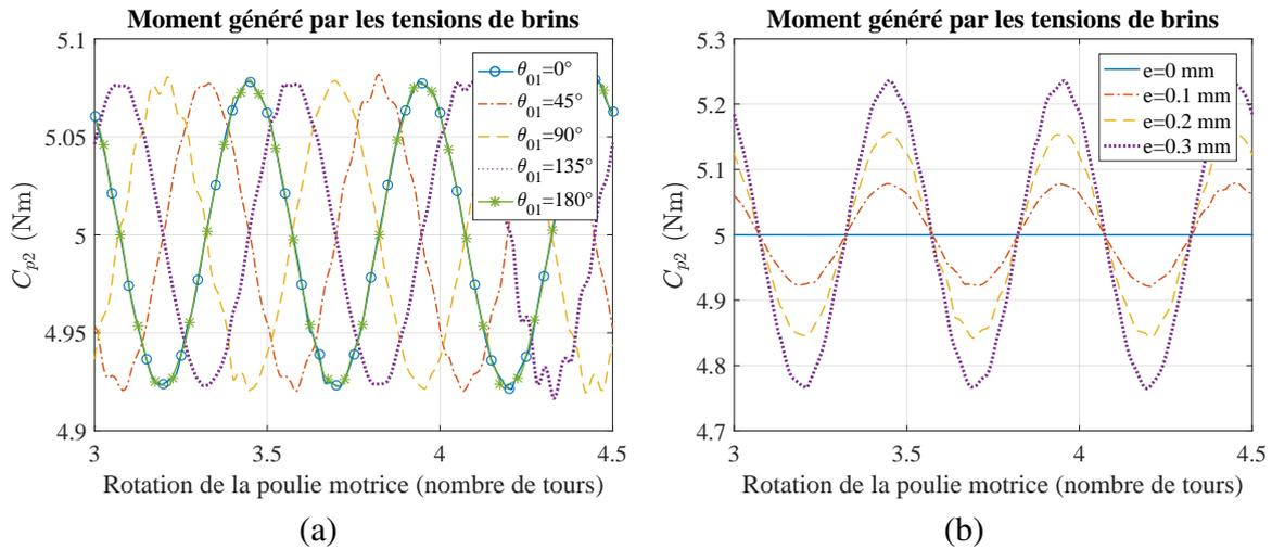
FIGURE 2.21 – Moment  $C_{p2}$  généré par les tensions de brins sur la poulie consommatrice de la transmission dans sa variante  $V_{el}$  : effet de l'angle de calage initial  $\theta_{01}$  pour  $e = 0.1$  mm (a) et effet du niveau d'excentricité  $e$  pour  $\theta_{01} = 0^\circ$  (b)
