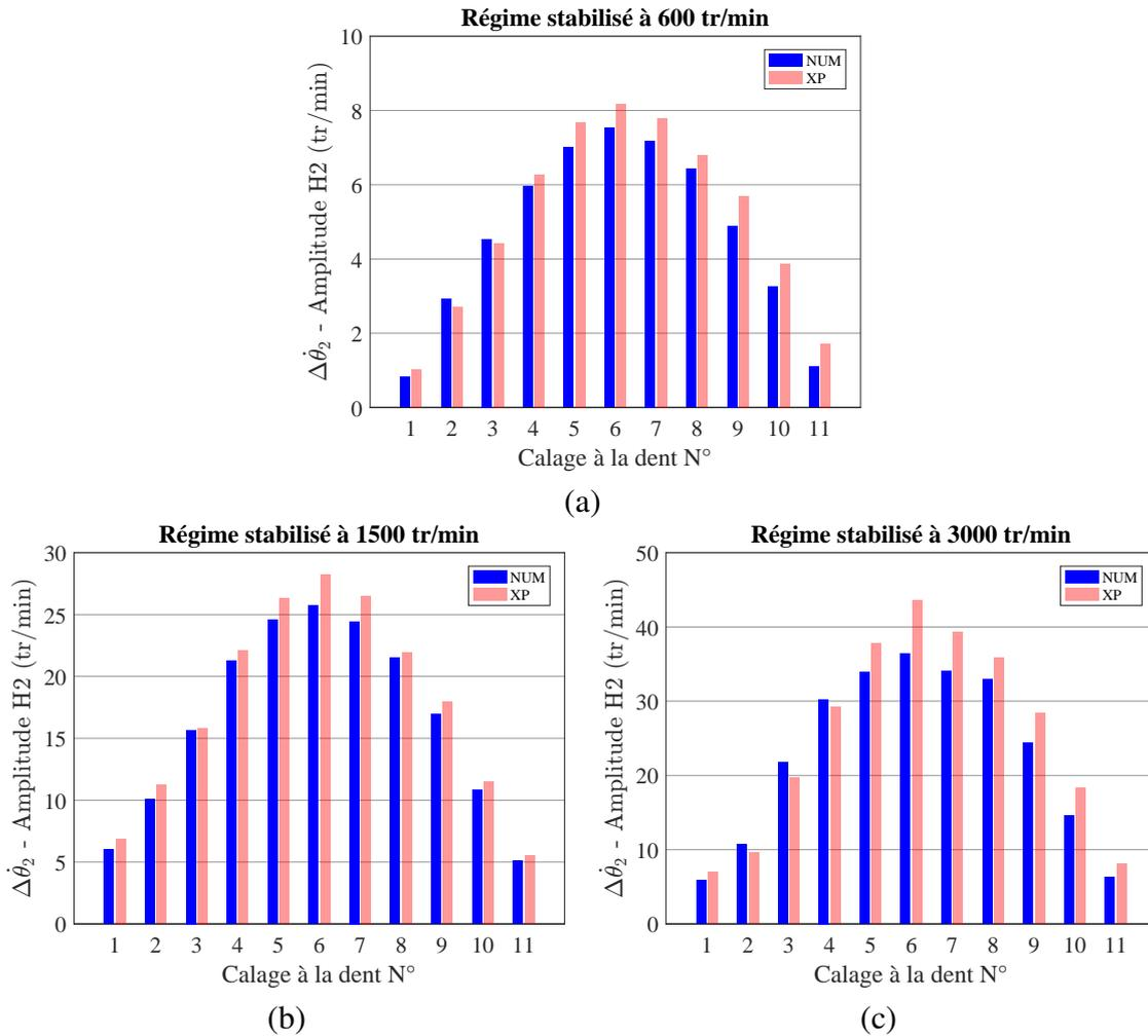
FIGURE 4.26 – Influence de l'angle de calage de la poulie motrice bilobée sur l'amplitude de l'harmonique H2 des signaux expérimental et numérique de la vitesse angulaire de la poulie menée  $\dot{\theta}_2$  pour des régimes moteur stabilisés à 600 (a), 1500 (b) et 3000 (c) tr/min
