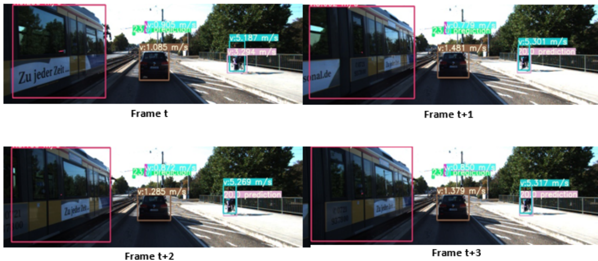
FIGURE 3.12: Résultats du suivi d'objets dans un environnement routier sur une séquence du jeu de données KITTI.
