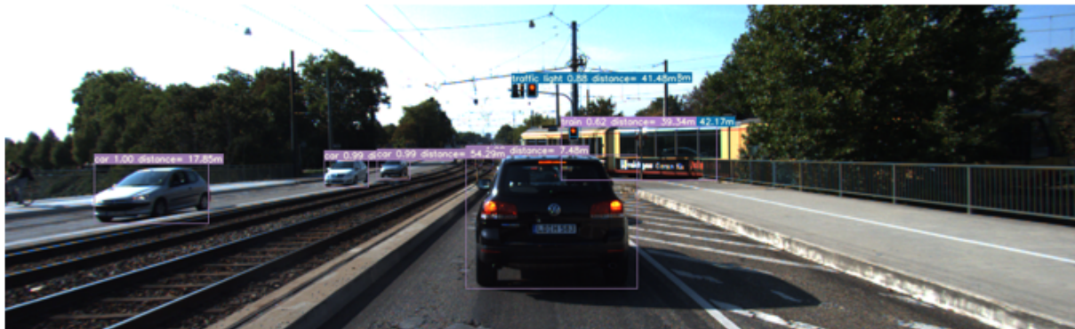
FIGURE 3.10: Résultats de la détection et de la localisation d'objets sur un échantillon du jeu de données KITTI.
