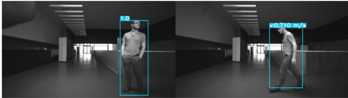
FIGURE 3.11: Résultat de l'approche de suivi sur une scène d'intérieur. L'image de gauche est acquise à l'instant t = 1 et celle de droite à l'instant t + 3 . A t = 1 , nous attribuons un ID à chaque objet détecté. Ensuite, à t + 3 , le tracklet est validé et nous affichons la vitesse estimée.
