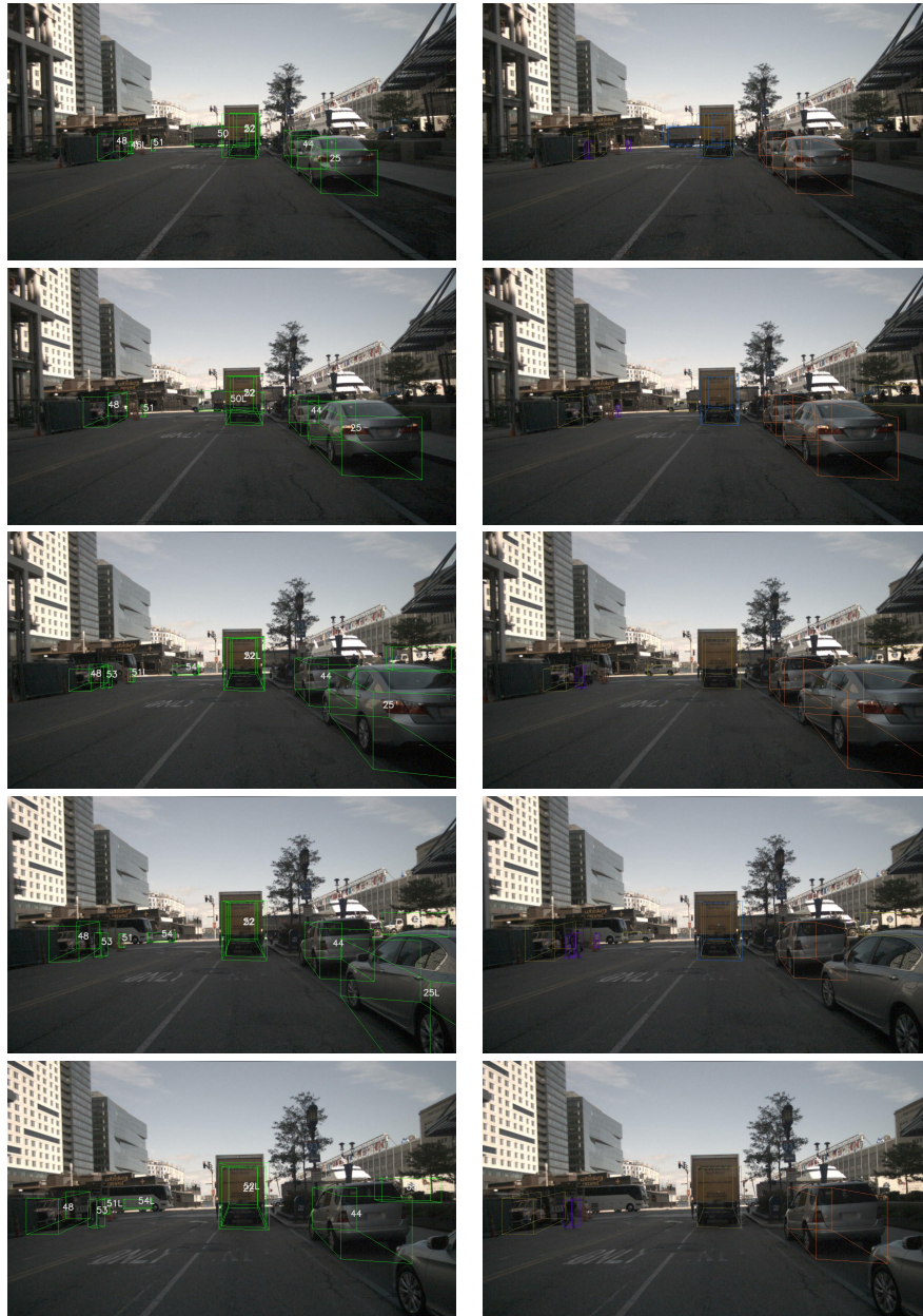
FIGURE 6.13: Résultats obtenus par notre méthode de suivi d'objets 3D. Le modèle "Large" entraîné sur la base de données Nuscenes a été utilisé pour détecter les objets 3D. Les images présentées dans la Figure font partie d'une séquence de validation fractionnée. Dans la colonne de gauche sont présentés les résultats du suivi d'objet avec l'ID de l'objet au centre des boîtes. La lettre L indique qu'un objet est "perdu", aucune détection n'a été associée au tracklet mais nous continuons à le suivre quelques images avant de l'effacer. Dans la colonne de droite sont présentés les résultats de notre détecteur d'objets 3D.
