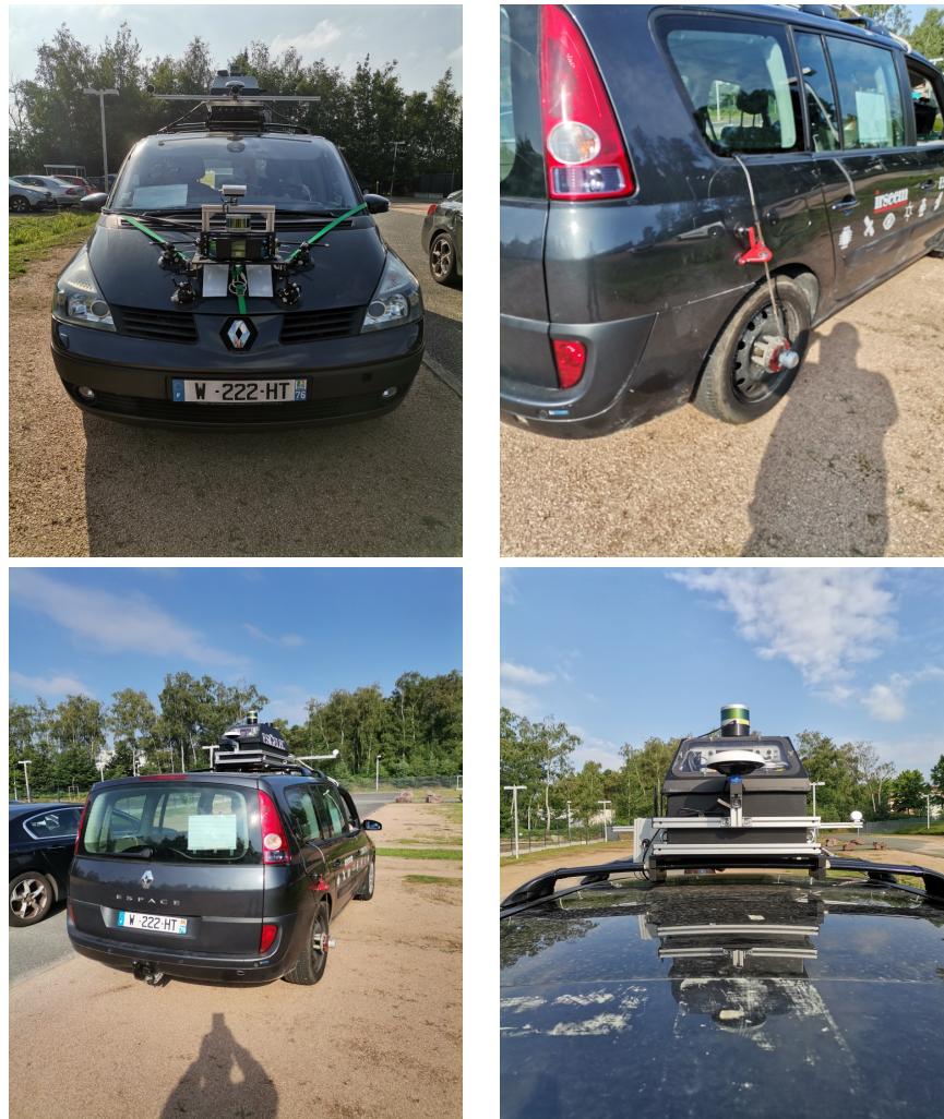
FIGURE 5.3: Véhicule IRSEEM instrumenté pour la collecte de données dans la mobilité intelligente. Le coffre de la voiture sur le toit du véhicule comprenant l'ensemble des capteurs (Caméras, GPS/IMU, LiDAR, RADAR, Odomètre). Le capteur de l'odomètre instrumenté sur la roue arrière droite.
