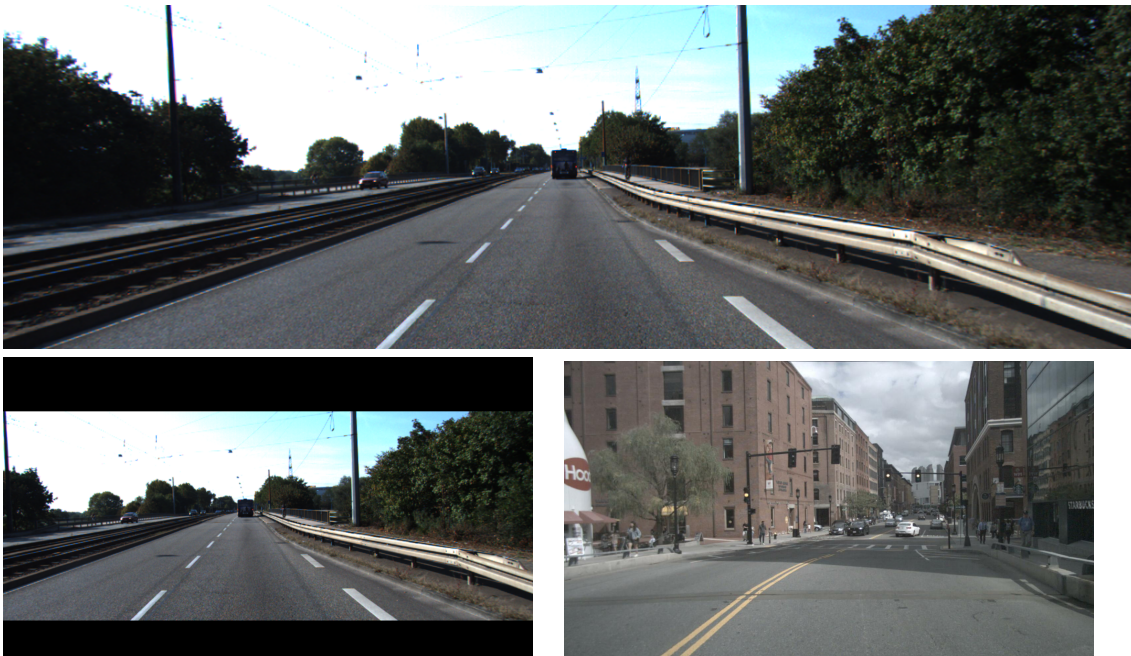
FIGURE 6.11: Exemple d'une image provenant du jeu de donnée KITTI transformé en image similaire à celles présentes dans la base de donnée NuScenes. L'image du haut est l'image originale de KITTI, celle d'en bas à droite est une image tirée de NuScenes et celle d'en bas à gauche est l'image de KITTI transformée.
