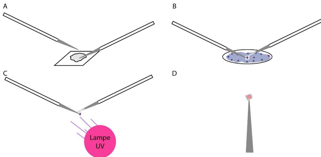
Figure IV-14 : Schéma du principe d'isolement des particules par fixation sur une pointe en tungstène. **A.** Pointe humectée avec la colle UV ; **B.** Micromanipulation de la particule enrobée de collodion, la pointe enduite de colle exerce une pression pour maintenir la particule ; **C.** Polymérisation de la colle par irradiation avec la lampe UV pendant quelques minutes ; **D.** La particule est fixée sur la pointe de tungstène.
