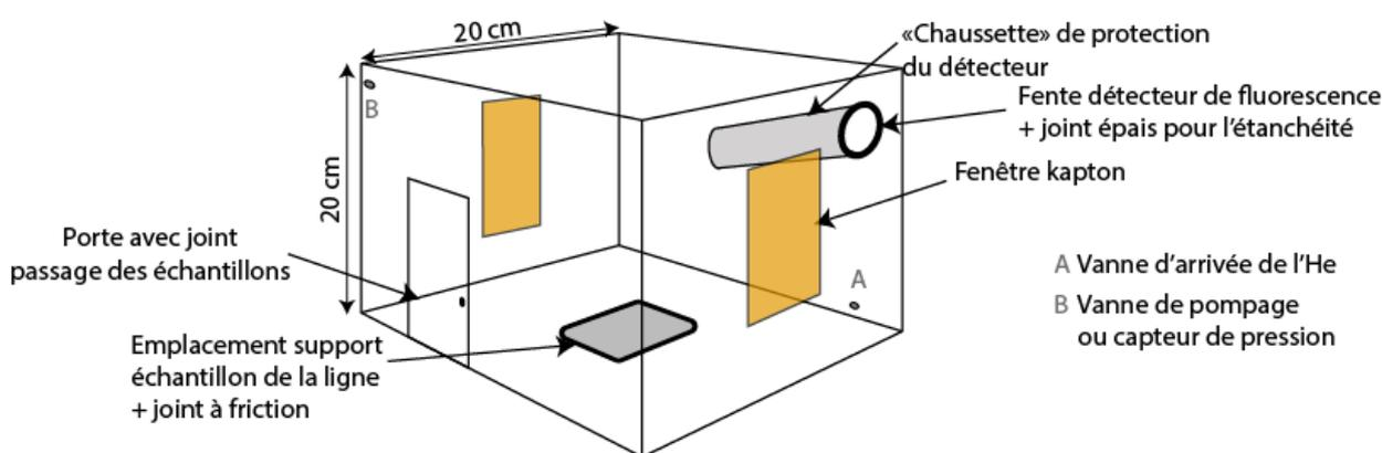
Figure VI-5 : Schéma de l'enceinte à atmosphère contrôlée.
