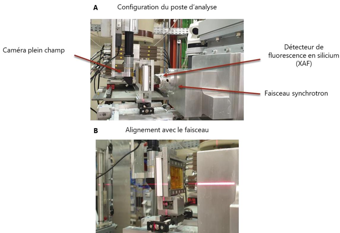
Figure VI-3 : Photographies : **A.** de la configuration de la zone expérimentale de la ligne MARS pour la caractérisation des particules de sol ; **B.** Alignement d'une particule avec le faisceau de rayons X.
