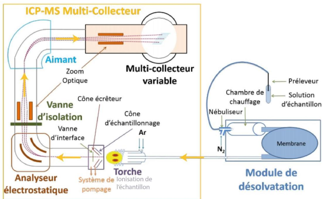
Figure II-7 : Schéma de l'ICP-MS multi-collection couplé à un désolvateur (Jaegler, 2018). Les flèches jaunes représentent le sens de transfert des ions.
