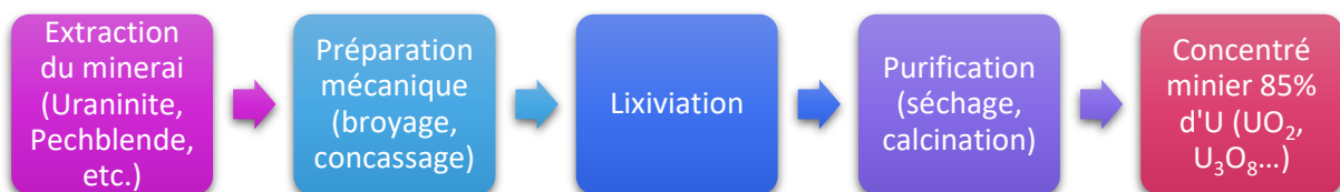
Figure I-4 : Présentation des étapes de transformation du minerai en concentré minier.
