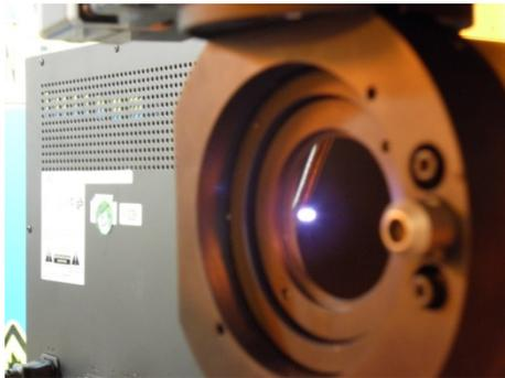
**Photo 31 : Plasma généré dans l'air lors du réglage de la tache image de l'installation d'endommagement Mistral**
