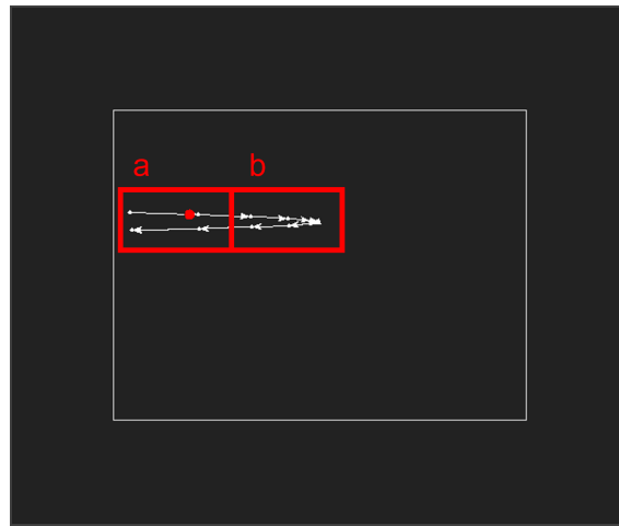
FIGURE 2.15 – (a) Zone de déplacement à vitesse constante et (b) zone de déplacement ralenti dans le virage.
