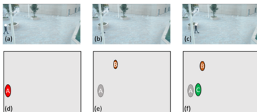
FIGURE 4.7 – (a) Un individu entre dans l'image, (b) l'individu passe derrière un obstacle, (c) l'individu n'est plus caché, (d) le point représentant l'individu de l'image (a) est identifié, (e) l'individu identifié en (d) est perdu, (f) l'individu identifié en (d) est toujours perdu et un autre individu est identifié dans l'image (c).
