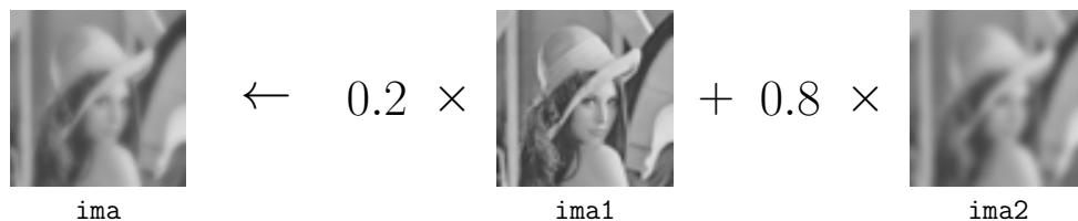
Figure 4: Algorithme mélange alpha (alpha-blending) écrit au niveau de l’image.
