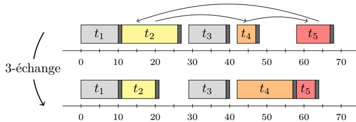
FIGURE 2.7 – Exemple de mouvement de 3-échange des durées.
