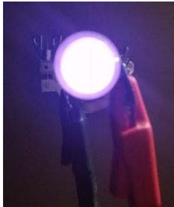
Figure 36: Photo radiale du plasma d'argon dans la lampe \beta .
