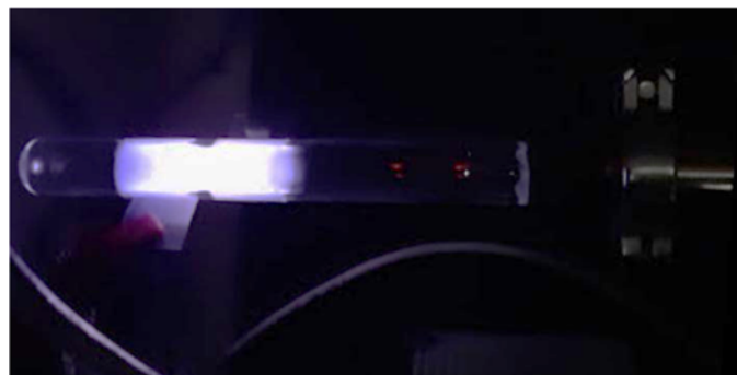
Figure 8 : Plasma de Krypton dans la lampe \beta à un gap de 1 cm avec l'insertion d'électrodes transparentes.
