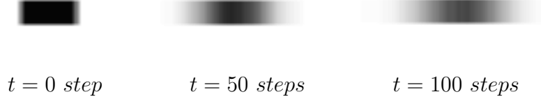
FIGURE 3.8 – Images représentant la probabilité de présence d’un obstacle à trois instants différents dans le cas d’un mouvement le long d’une ligne droite. Plus un pixel tend vers le noir, plus sa probabilité d’être occupé par l’obstacle est élevée.
