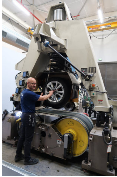
FIGURE 4.14 – Machine de test des pneumatiques « Flat-Trac ». Photographie d'une Flat-Trac du site de Belchamp, parue dans l'Est Républicain le 19 décembre 2018.
