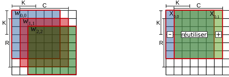
(a) Superposition des sous-ensembles multipliés par les poids (seuls 3 sous-ensembles sur 9 sont représentés)
