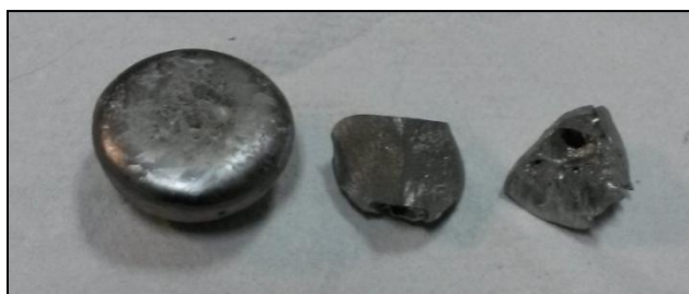
Figure A.IV. 1 - Photographie des lopins en sortie du creuset froid, de gauche à droite : nuances à base Fe, FeCo et FeNi.
