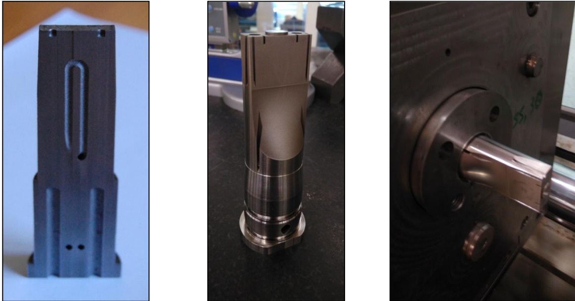
Figure A.V. 7 - Broche pour moule prototype fabriquée par SLM : section transversale du brut de fabrication à gauche, broche usinée au centre et insert fixé dans le moule d'injection à droite.
