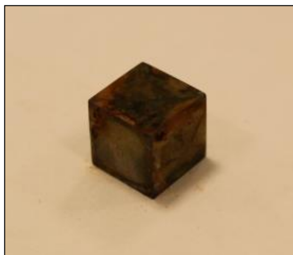
Temps d'immersion : 672h Acier Maraging 300 traité thermiquement
