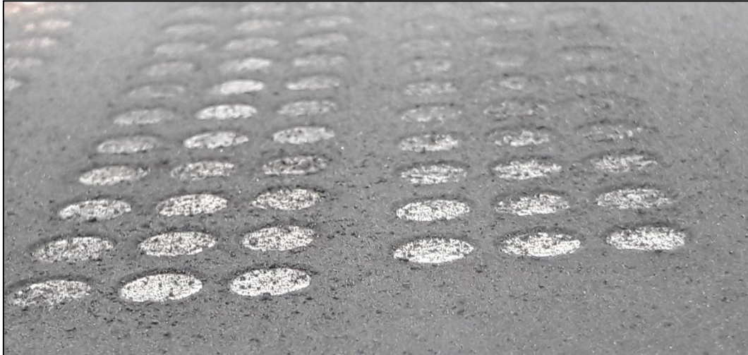
Figure IV. 19 - Photographie du plateau de fabrication à la fin d'une étape de lasage.
