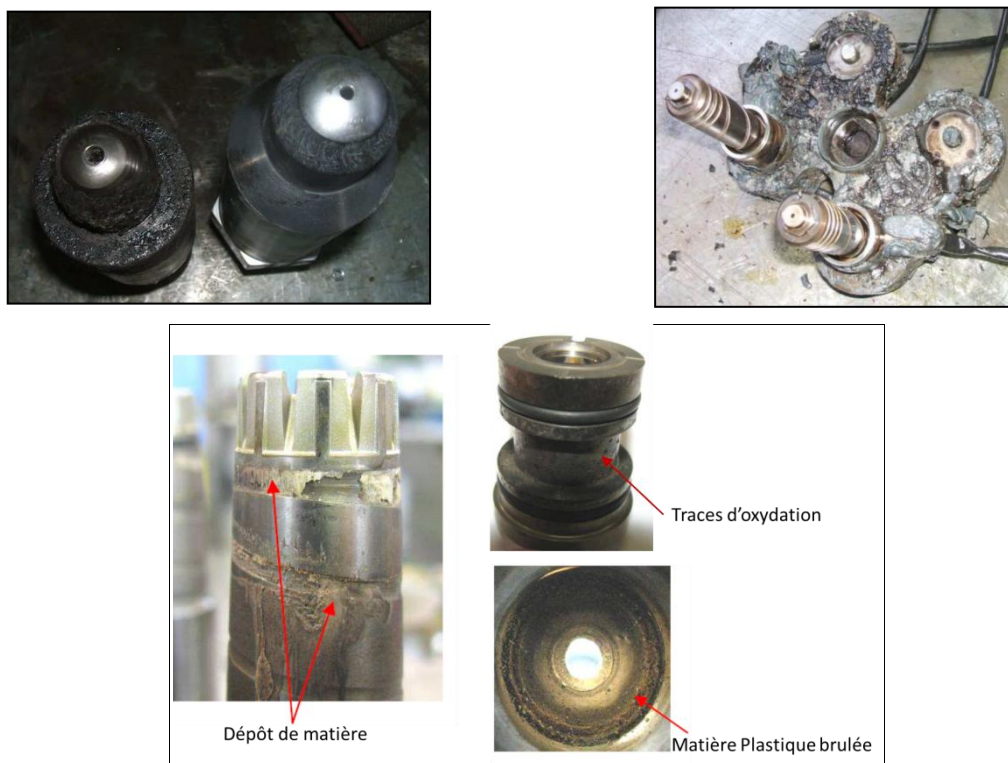
Figure 1 - Dégradation des inserts de moule d'injection plastique après 6 mois d'exploitation (projet MOULINNOV).
