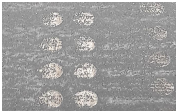
Figure A.IV. 17 - Photographie de lit de poudre lors d'une mise en couche non optimale.
