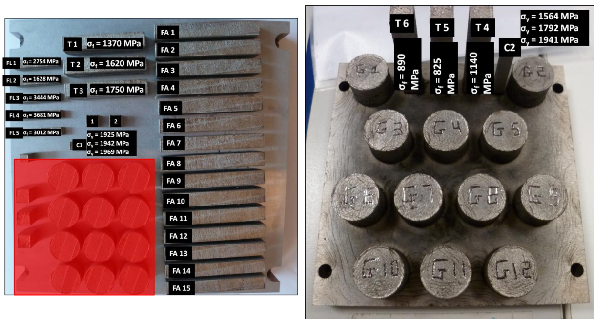
Figure A.V. 2 - Positions des éprouvettes mécaniques sur leur plateau de fabrication.
