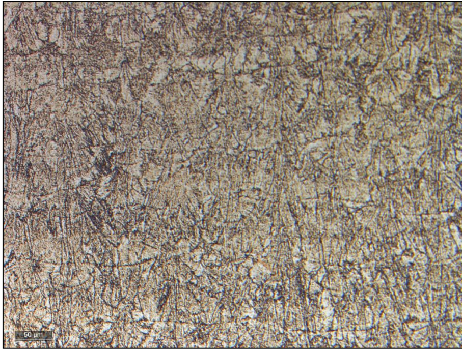
Figure A.III. 10 - Micrographie optique en fond clair d'un échantillon trempé et revenu, poli et attaqué chimiquement au MARBLE ( T_{aust} = 1050^{\circ}\text{C} pendant 30 min, T_{rev} = 650^{\circ}\text{C} 1 h).
