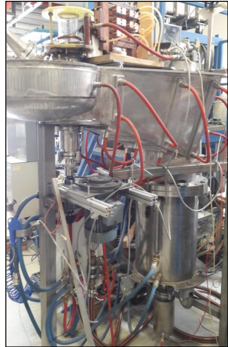
Figure IV. 3 - Schéma de principe de l'atomisation par plateau tournant et photographie de l'équipement développé par Tita Creuset.
