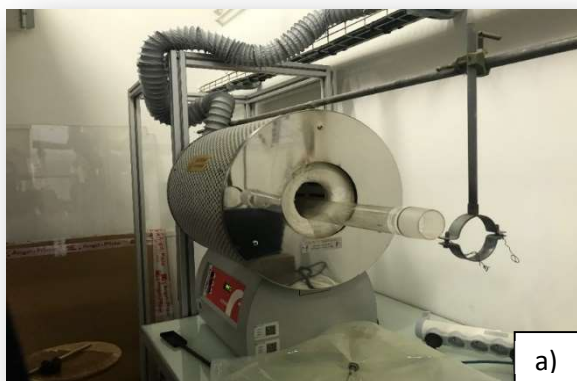
Figure 2.7. Four tubulaire horizontal a) avant pyrolyse du matériau b)
