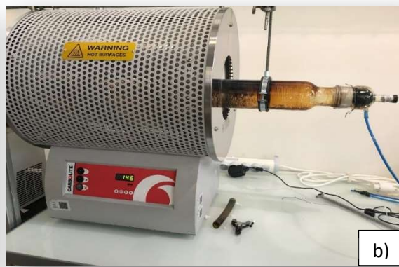
Figure 2.7. Four tubulaire horizontal a) avant pyrolyse du matériau b)
