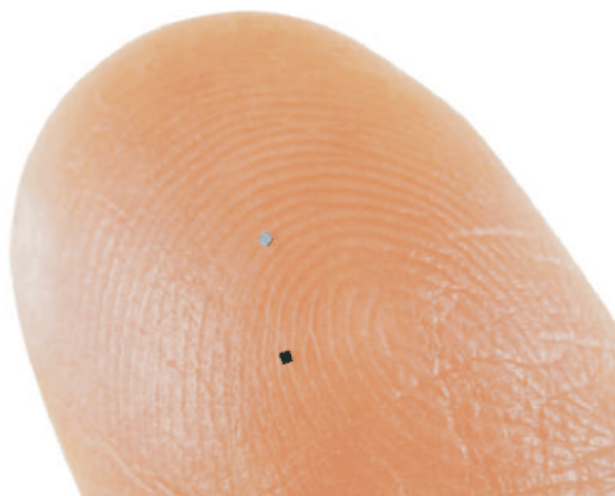
Figure I.9 : Puce RFID UHF de Hitachi de surface 0,4x0,4mm
