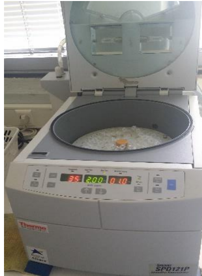
Figure 13. Concentrateur utilisé pour sécher l'ensemble des bactériocines purifiées dans ce travail
