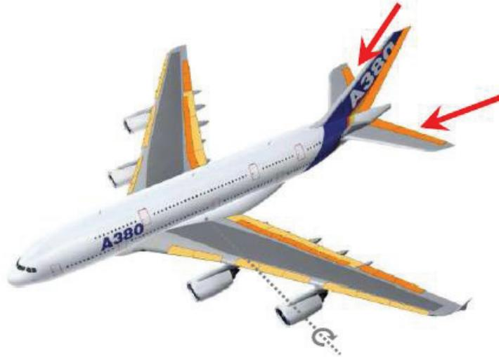
Figure I.6 : Manœuvre selon l'axe de tangage (Dupin 2009)
