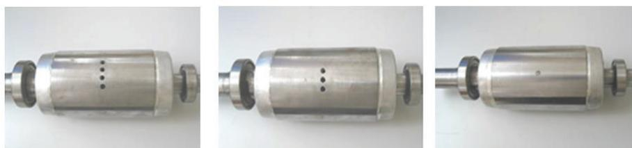
Figure IV.5 : Emulation des défauts de barres cassées
