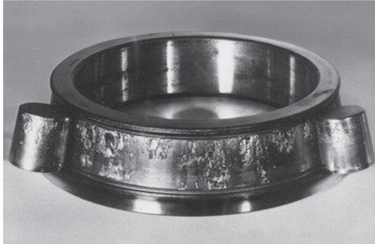
Figure I.16 : Roulement à rouleaux écaillé (SKF 1994)
