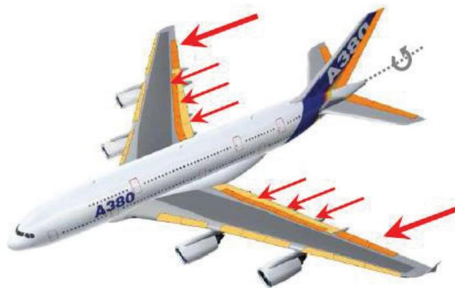
Figure I.5 : Manœuvre selon l'axe de roulis (Dupin 2009)
