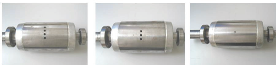
Figure IV.5 : Emulation des défauts de barres cassées
