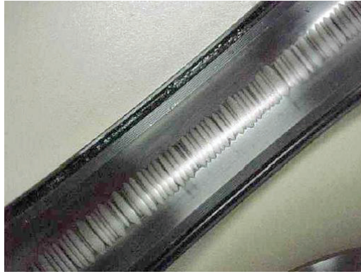
Figure I.18 : Marques caractéristiques dues au passage de courants (Bishop 2017)
