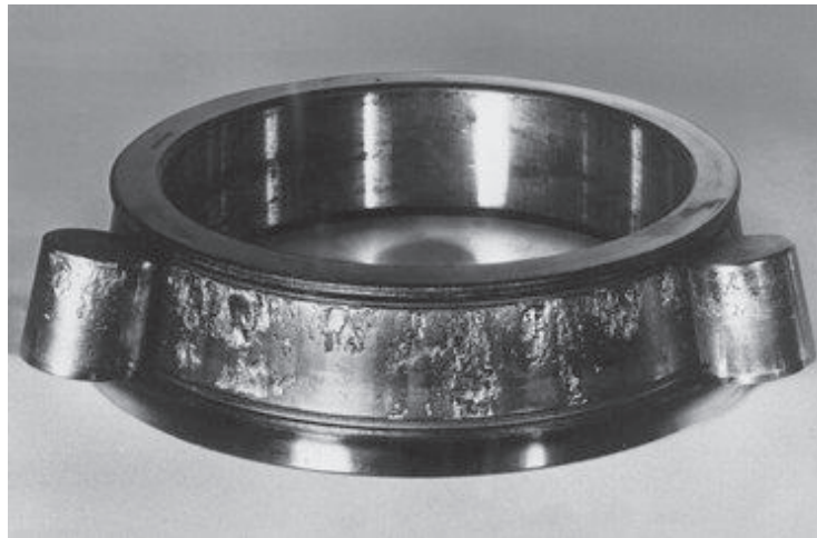
Figure I.16 : Roulement à rouleaux écaillé (SKF 1994)
