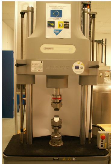
FIGURE 3.11 – Machine de traction utilisée lors des essais de traction cyclique.
