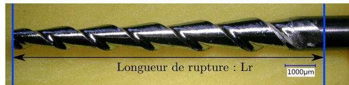
FIGURE 4.15 – Mesure de la longueur de rupture d'un instrument à l'issue de la campagne expérimentale de fatigue.
